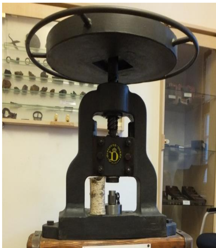
Obr. 5 Razící šroubový lis [12]
