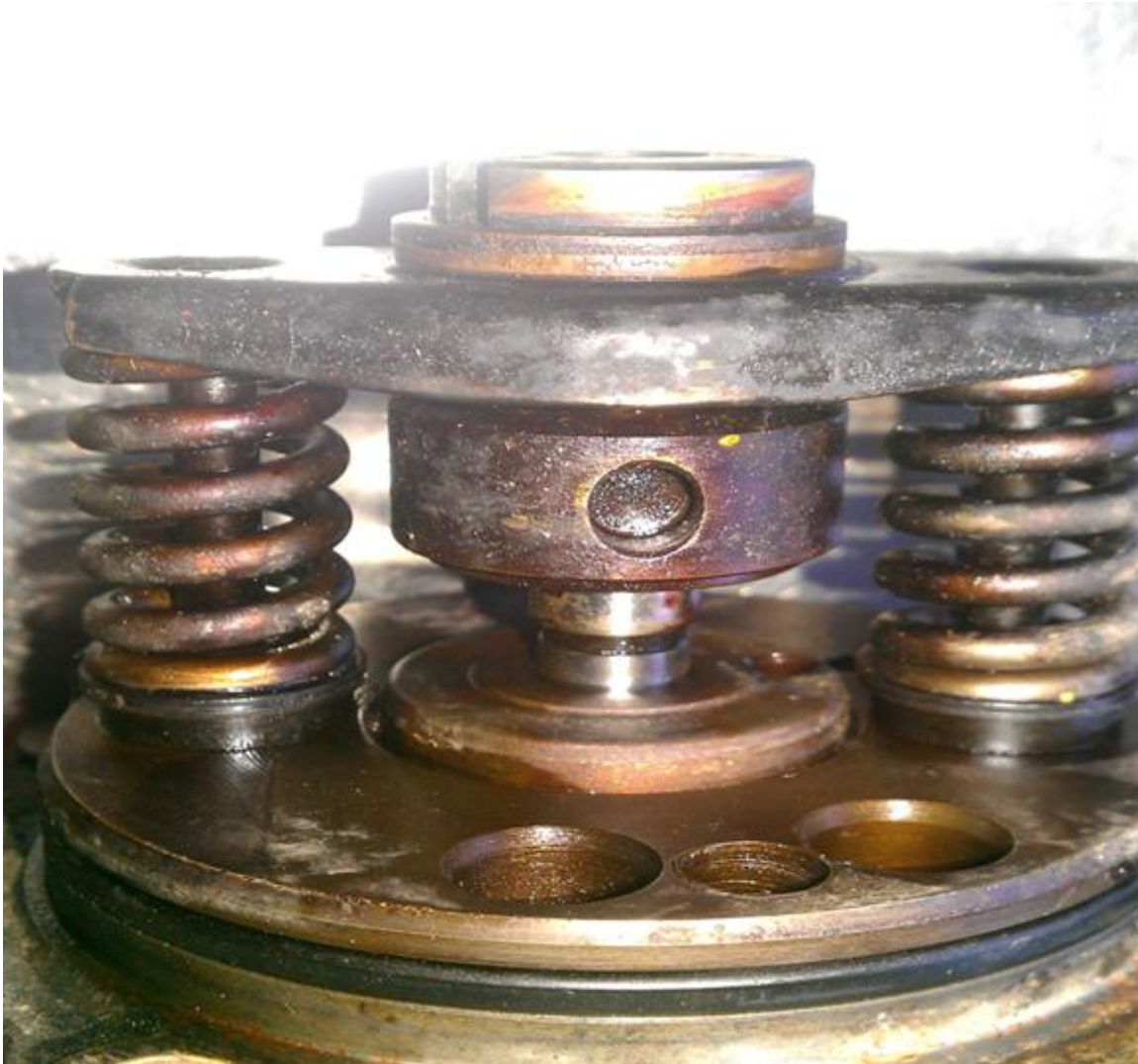
Obr.3-8 regulační objímka potažená narezavělým povlakem.
