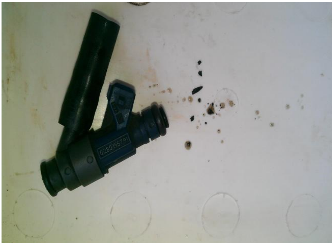
Obr 3-18 Vstřikovač s úlomkou pryže a nečistotami ze vstupního hrdla.
