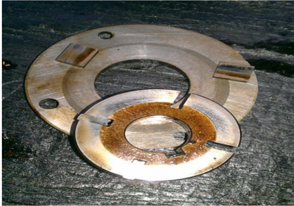
Obr. 3-10 Díly podávacího čerpadla potažené narezavělým povlakem
