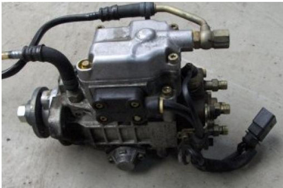
Obr. 3-7 Připravené vstřikovací čerpadlo na vlastní demontáž.
