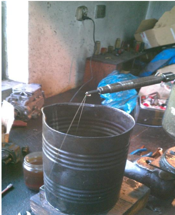
Obr.3-4 Vstřikovač č.4 netěsnost
