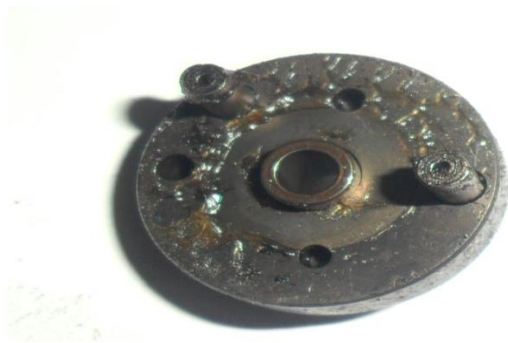
Obr.3-6 Zalepená dělicí destička vstřikovače č.4
