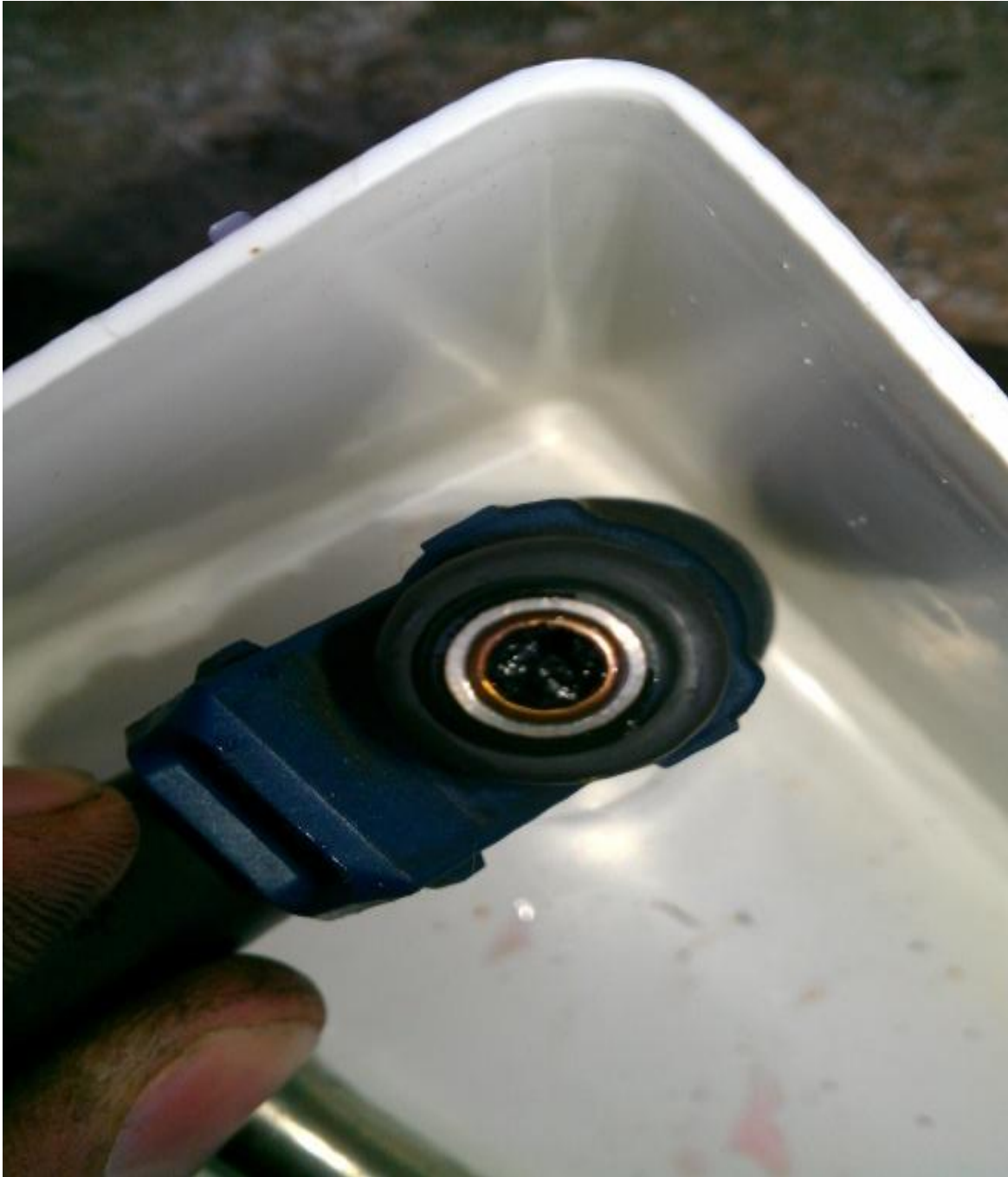
Obr 3-17 Ucpané vstupní hrdlo vstřikovače.
