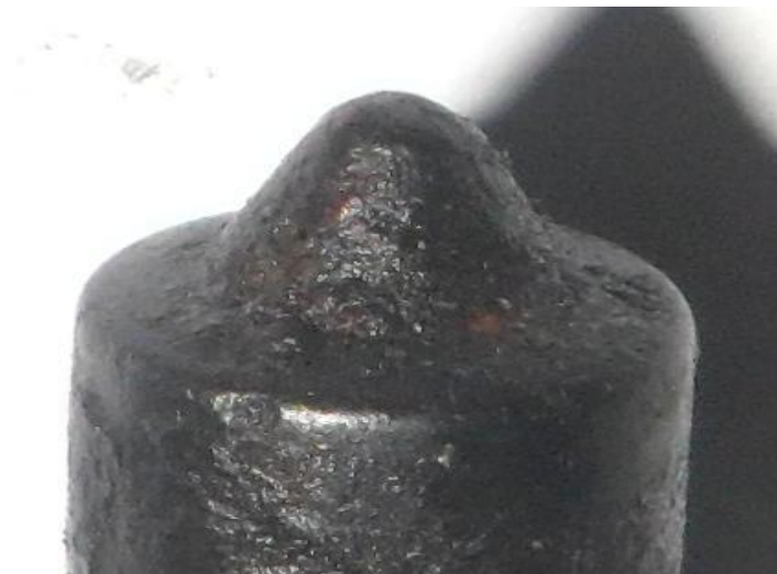
Obr. 3-2 Detailní obrázek trysky vstřikovače č.4
