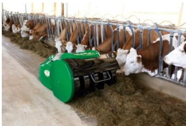
Obrázek 16 Autonomní šnekový přihrnovací robot firmy Wassenbauer [5.1.1]
