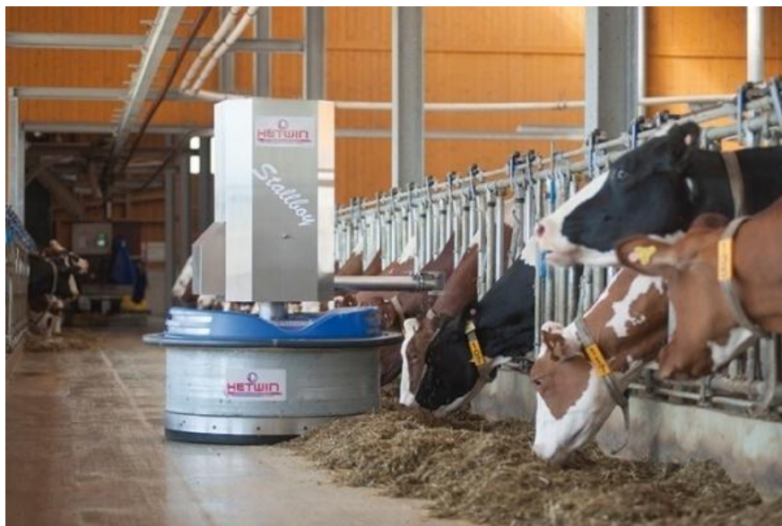
Obrázek 19 Autonomní příhrnovač firmy Hetwin se zásobníkem na jadrné krmivo
