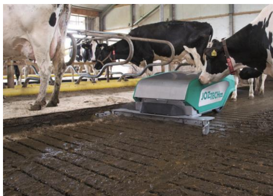
Obrázek 7 Shrnovací robot firmy JOZ [3.3.2]
