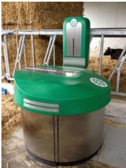
Obrázek 18 Autonomní robotický přihrnovač firmy JOZ [5.2.2]
