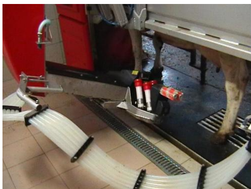
Obrázek 4 Robotické rameno dojícího automatu firmy Lely [3.2.3]
