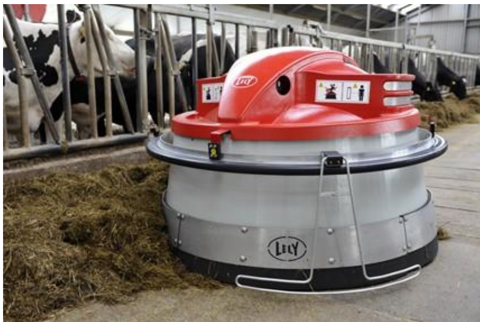
Obrázek 17 robotický příhrnovač firmy Lely [5.2.1]
