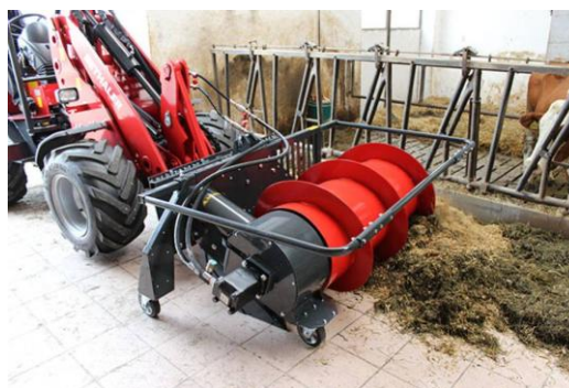
Obrázek 12 Šnekový přihrnovač firmy Mammut [4.1.3]
