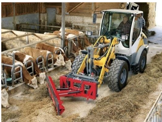
Obrázek 10 Přihrnovací radlice s manipulátorem [4.1.1]
