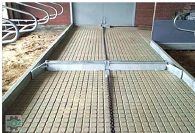
Obrázek 6 Shrnovací radlice tažená řetězem firmy JOZ [3.3.1]
