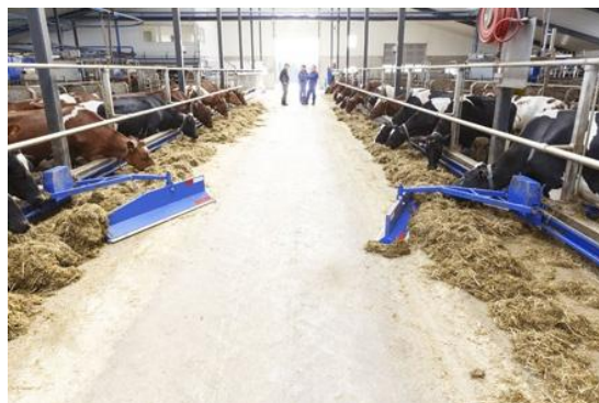
Obrázek 14 Tažená přihrnovací radlice firmy DeLaval [4.2.1]
