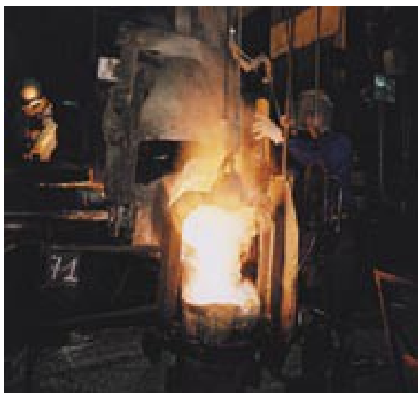
8 Obrázek 1-Lití do stromečků [2]
