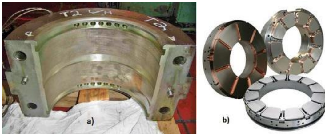
Obrázek č. 20: Radiální (a) a segmentové axiální (b) ložisko pro uložení rotoru.
