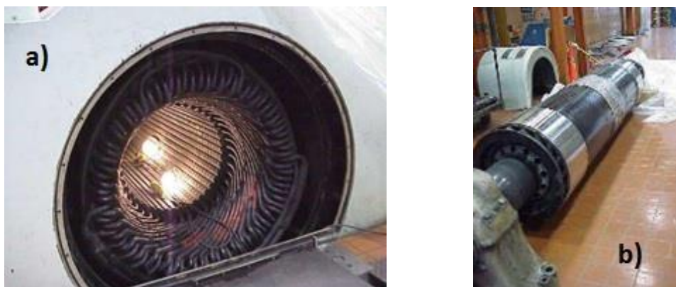
Obrázek č. 5: Stator (a) a rotor (b) generátoru.
