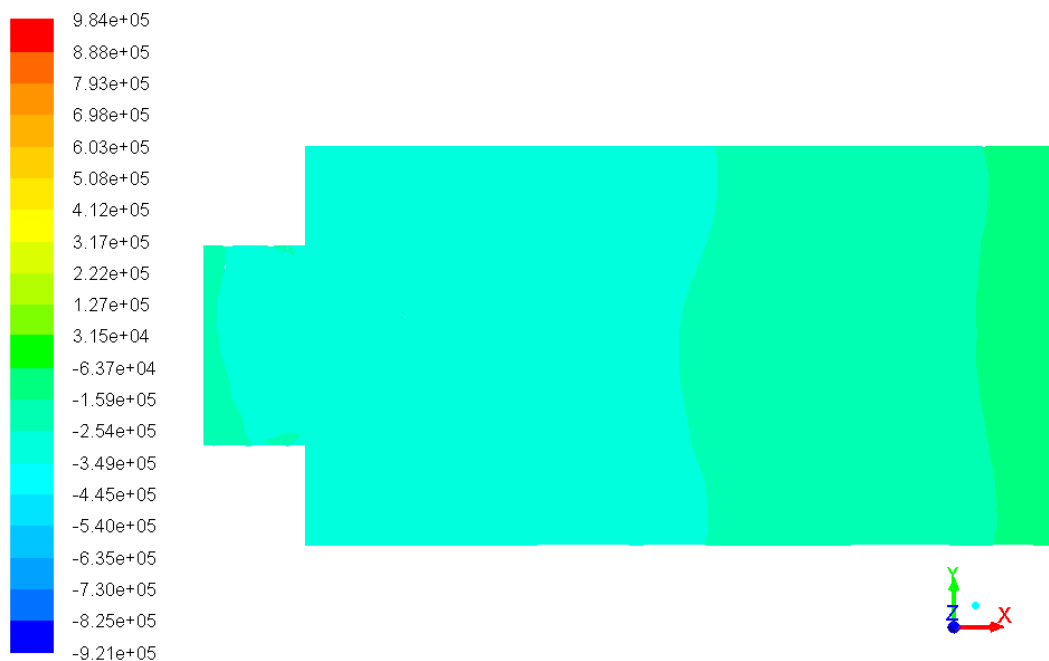
Obrázek 25 - Kontury tlaku na výstupu ze zúžení
