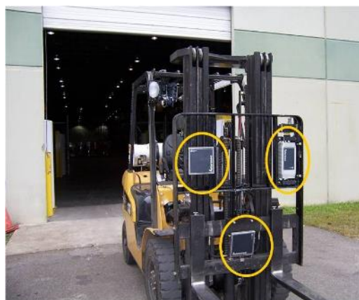
Obr. 2.7 Stacionární čtečka umístěná na vysokozdvížném vozíku (převzato z [17])
