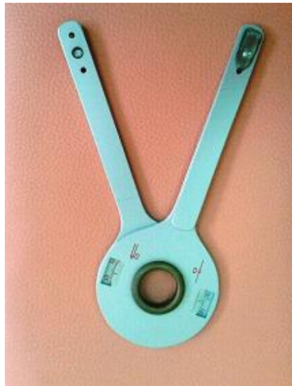
Obrázek 2 Mechanický dvouramenný goniometr
