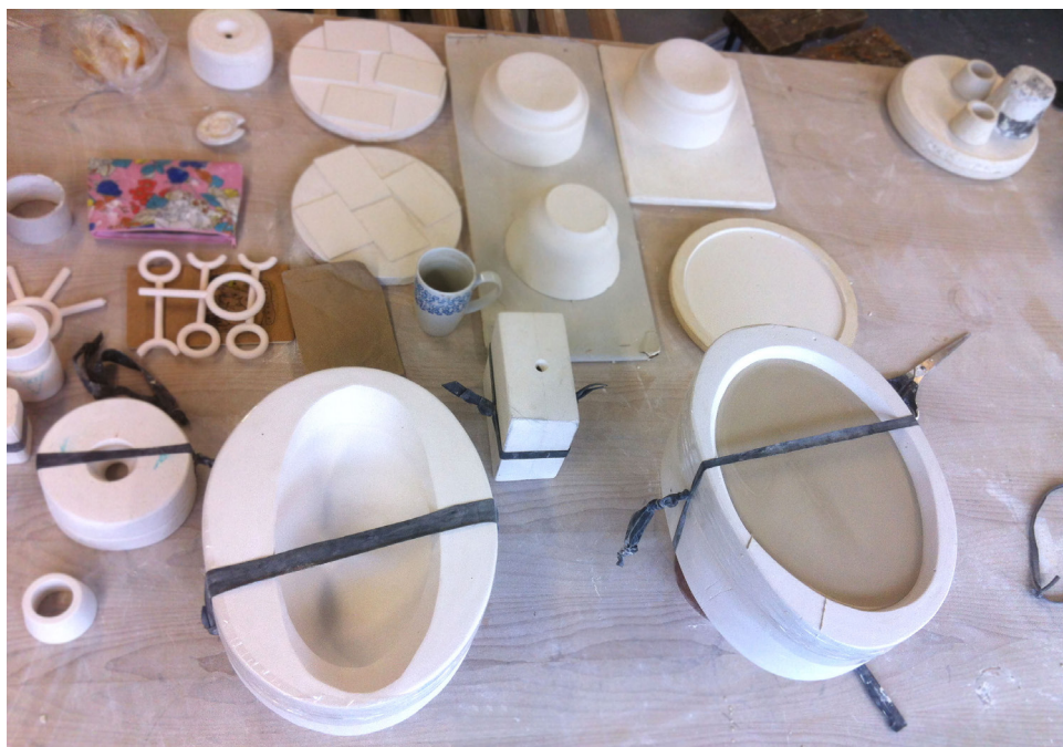
Objekt BOCCA: Proces odlévání do sádrových forem 1
