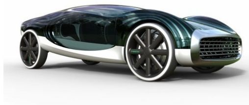
Obr. 11. Projekt Symbiosis využívá plně transparentní fotovoltaiku 16
