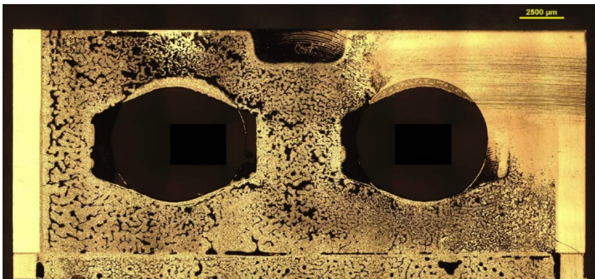
Obr. 3.5 Porezita pájeného spoje při použití tavidla bez příměsí
