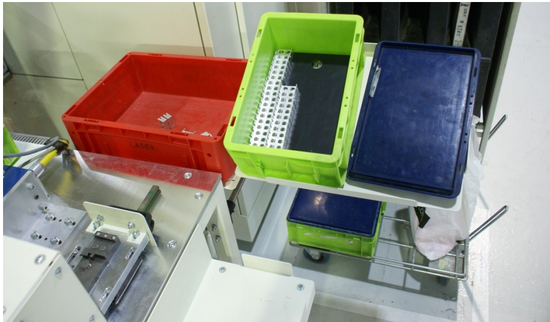
Obr. 4.14 Doplněný stojan s červenou bednou na odpad
