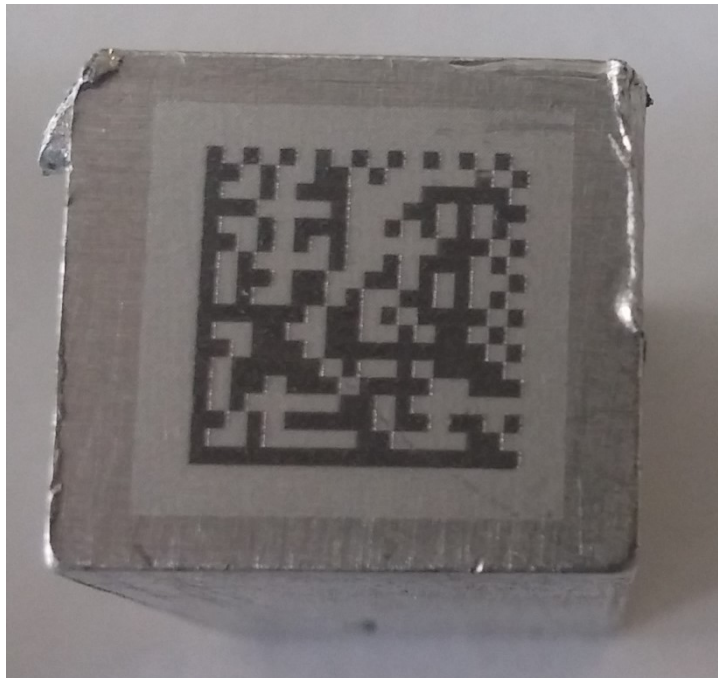
Obr. 4.2 Vypálený data matrix firmy 1 za 2,4 vteřiny.
