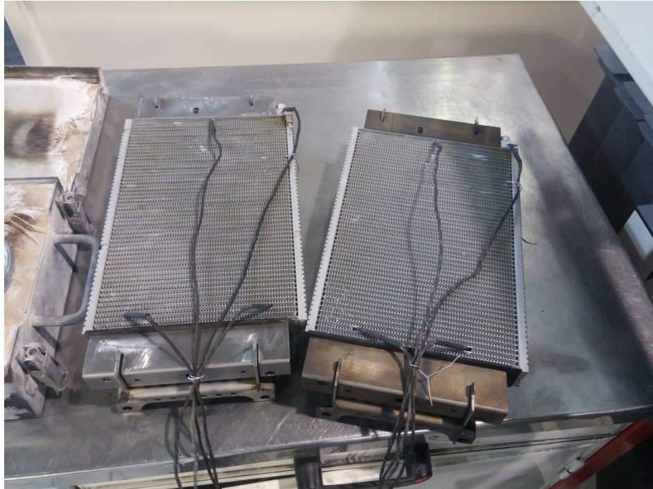
Obr. 3.10 Bloky s různými pájecími přípravky
