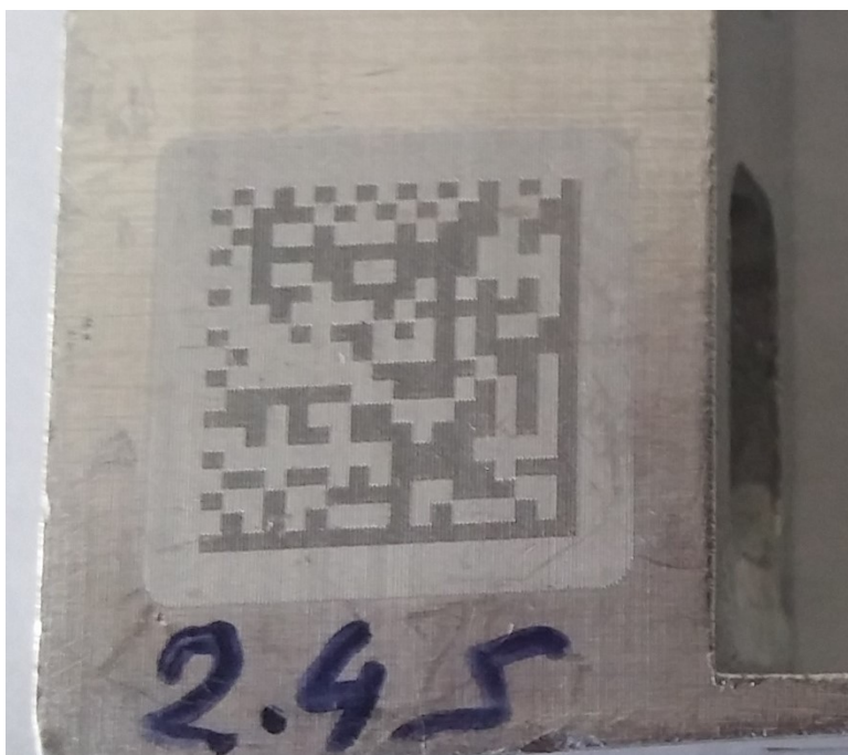
Obr. 4.3 Vypálený data matrix firmy 2 za 2,4 vteřiny.
