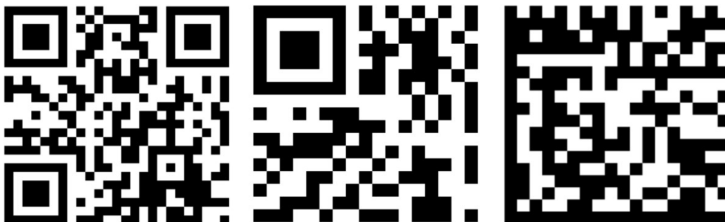
Obr. 2.1 typy čárových kódů – Zleva: QR, Micro QR a Data matrix
