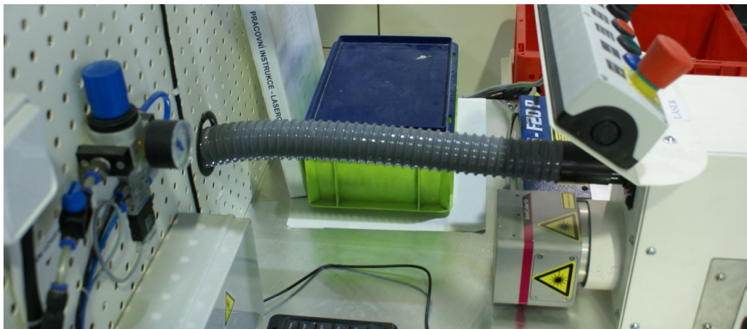
Obr. 4.13 Vyvedení odsávání přímo do zadní části stroje
