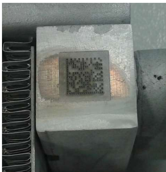
Obr. 2.4 Data matrix po pájení a vyleštění
