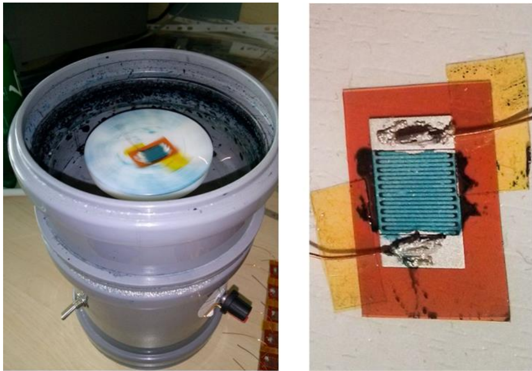
Obr. 20 Metoda spin coating a vzorek s vrstvou Ftalocyaninu
