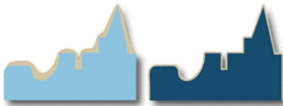
Obr. 11 Rozdíl mezi nanášením z kapalně a plynné fáze [6]
