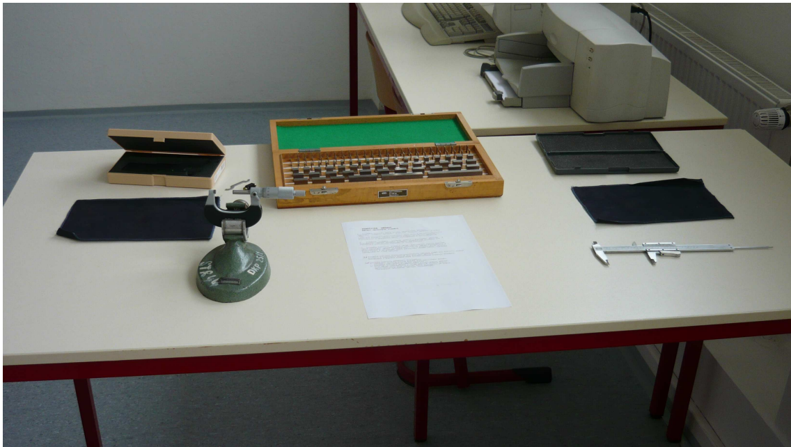
Obr. 4 - Stanoviště pro kontrolu přesnosti mikrometru a posuvného měřítka
