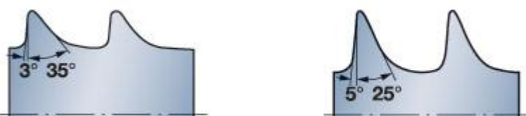
Obr. 16 Profilu závitů HA (vlevo) a HB (vpravo) [23]
