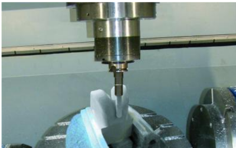
Obr. 12 Příklad použití CNC řezování - verifikace pětiosého CNC obrábění
