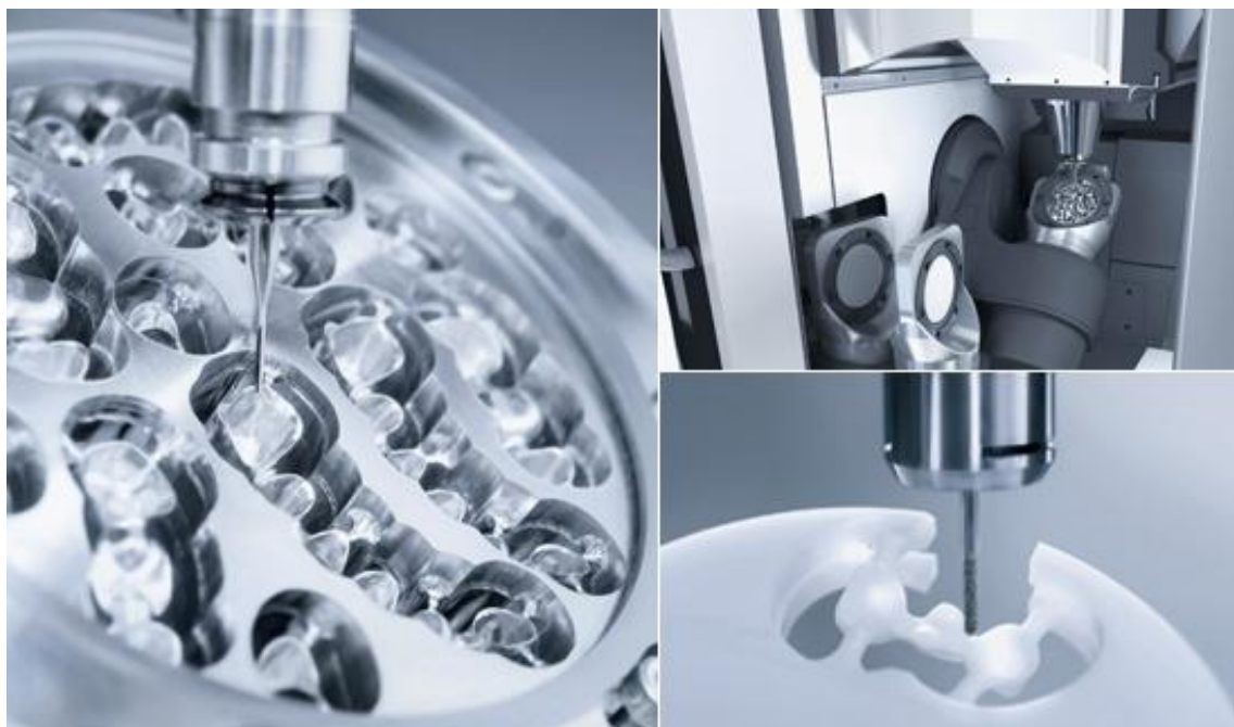
Obr. 31 Detailní pohled do stroje ULTRASONIC10 při výrobě můstků [12]
