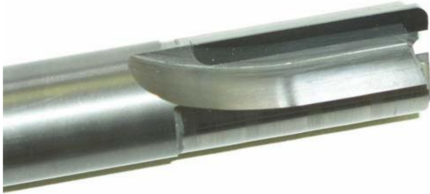
Obr. 4-9 Dvoubřítá fréza s PKD břity [19]
