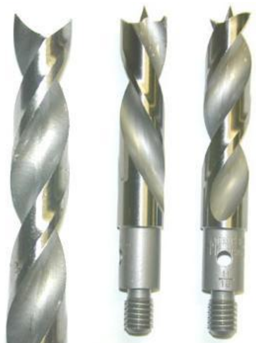
Obr. 4-4 Vrták FISHTAIL a vrtáky se geometrií pro vrtání FRP [20]
