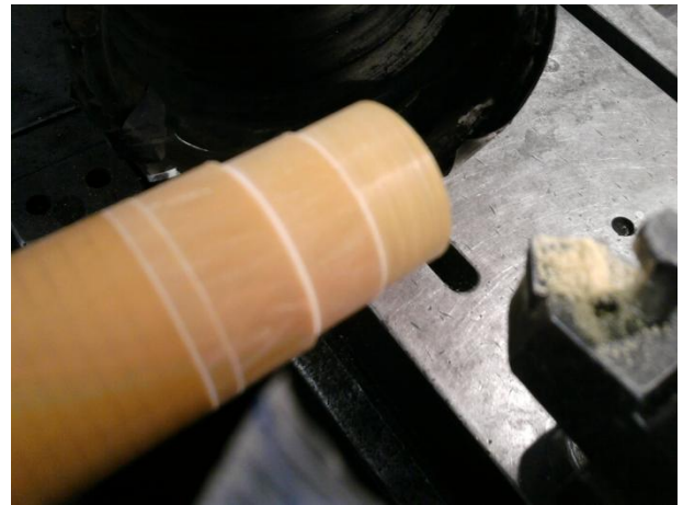
Obr. 3-5 Podélné soustružení sklolaminátu
