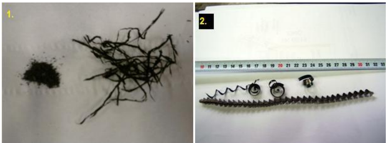
Obr. 3-1 Porovnání kompozitových (karbonových) a kovových třísek
