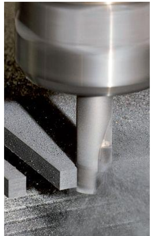
Obr. 3-16 Frézování kompozitu dvoubřítou frézou [13]
