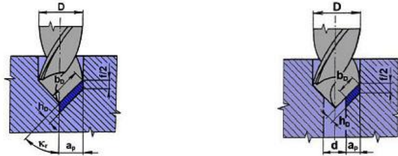
Obr. 1.2 Jmenovité rozměry třísek při vrtání šroubovitým vrtákem [3]
