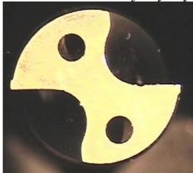
Obr. 4.7 Průřez profilu šroubovitého vrtáku (K285A03906) [22]
