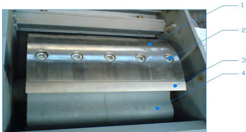
Obrázek 14: Rotor strojní sekačky po odklopení korního ochranného krytu.
