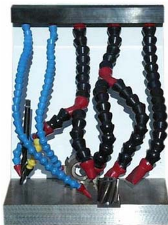
Obrázek 4.15 - Hadice na řeznou kapalinu (převzato z [8])
