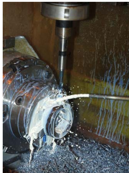
Obrázek 4.10 – Přívod řezné kapaliny
