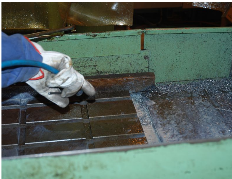
Obrázek 4.13 – Čištění tlakovým vzduchem
