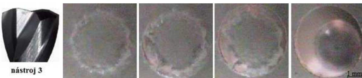
Obr. 4.3-7: Tvoření kloboučku na potaženém hliníku 2024 s nástrojem 3 [1]
