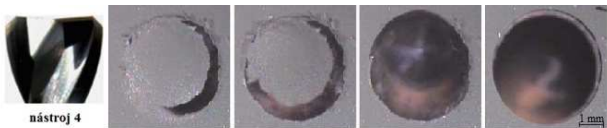
Obr. 4.3-8: Tvoření kloboučku na potaženém hliníku 2024 s nástrojem 4 [1]
