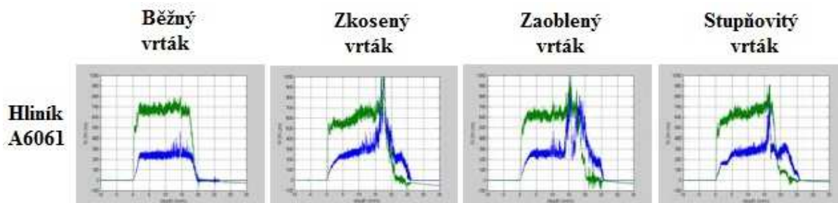
Obr. 3.4-9: Řezné síly u modifikovaných vrtáků při vrtání A6061 [3]
