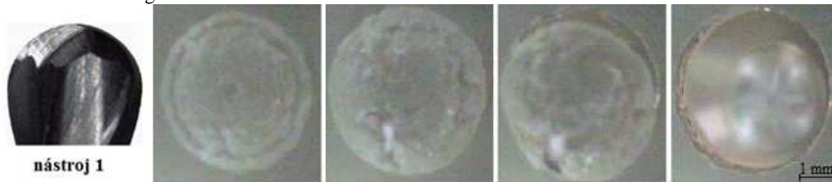
Obr. 4.3-5: Tvoření kloboučku na potaženém hliníku 2024 s nástrojem 1 [1]
