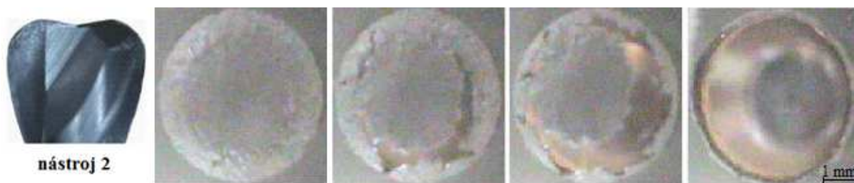
Obr. 4.3-6: Tvoření kloboučku na potaženém hliníku 2024 s nástrojem 2 [1]
