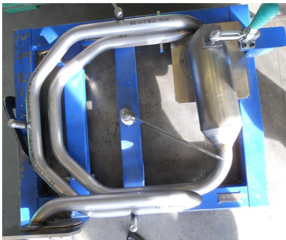
Obr. 19 Uložení tepelného výměníku do kontrolní šablony
