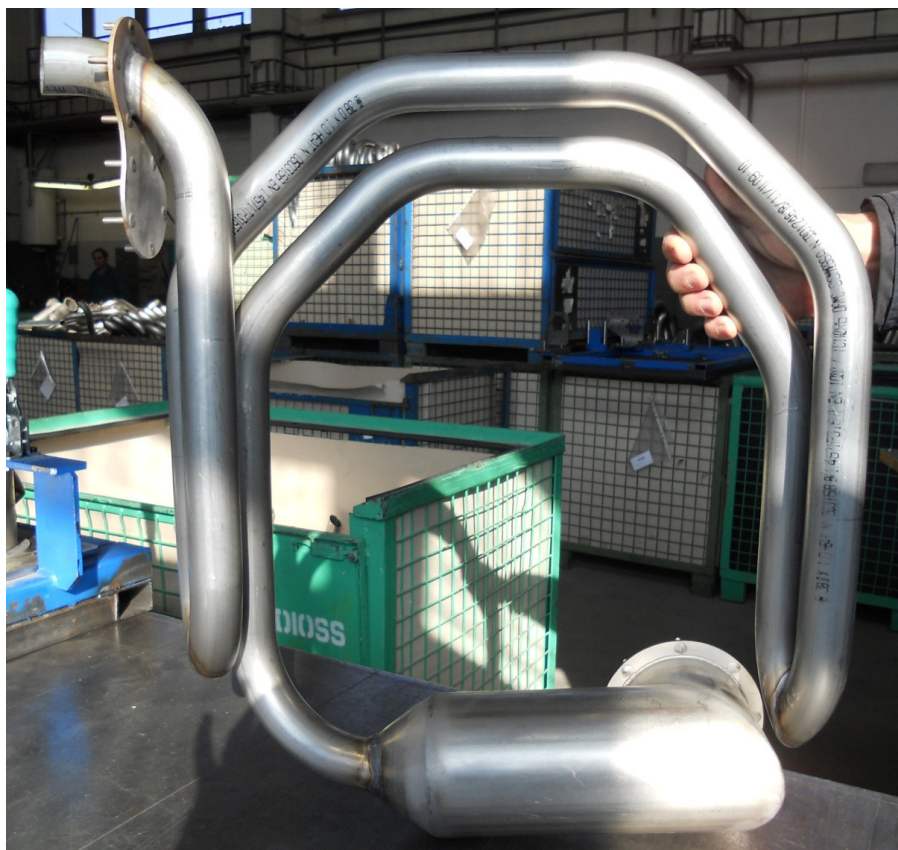
Obr. 18 Fotografie zkompletovaného tepelného výměníku
