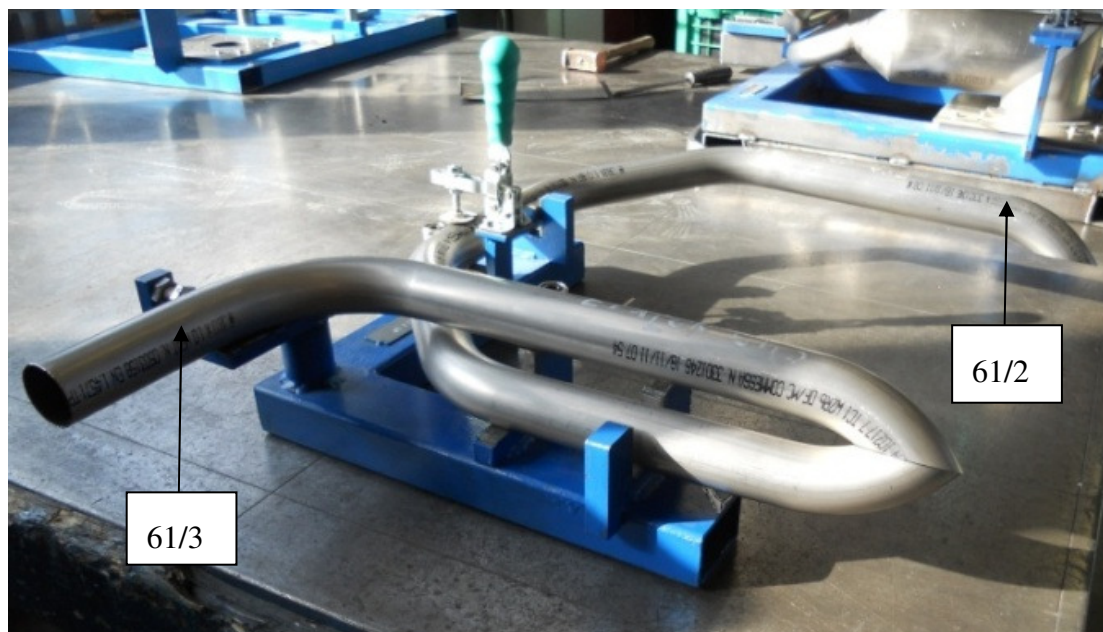
Obr. 21 Přípravek pro kontrolu polohy a délky trubek č. 2 a 3
