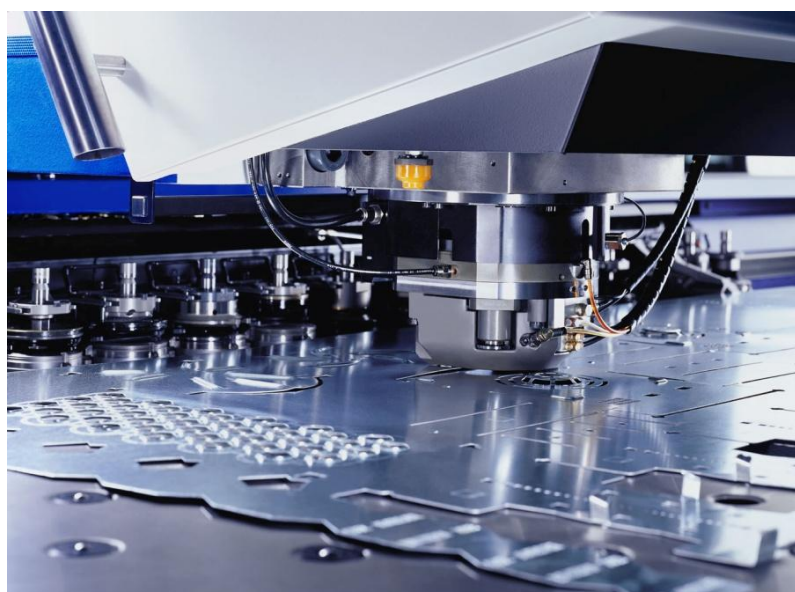
Obr. 3-6 Opracování na vysekávacím stroji TruPunch 5000R [4]
