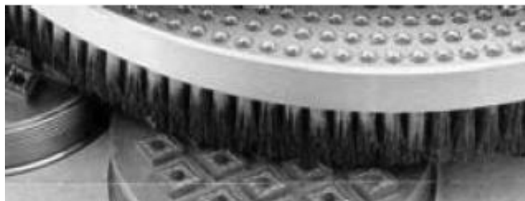
Obr. 2-21 Příklad kartáčování polotovarů VBD [2]
