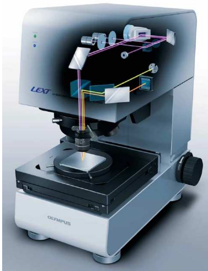
Obr. 5-9 Duální konfokální mikroskop Lext OLS4000 [18]
