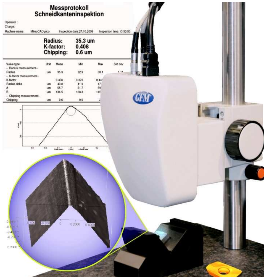
Obr. 5-4 Měřící systém MicroCAD s protokolem o měření [24]
