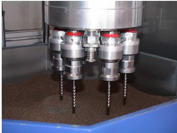
Obr. 2-13 Pohled do zařízení na omílání v granulátech [28]
