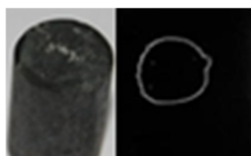
Obr. 7-5: Vzorek 5:(doba černění 40 min.)_Vyhovující korozivní odolnost, došlo k částečnému naleptání povlaku ne k jeho rozpuštění
