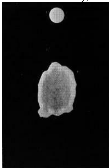
Obr. 6-3: Povlak špatné kvality (nevyhovuje)[10]
