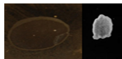
Obr. 3-18: Vzorek 9.2:(doba černění 45 min.)_Nevyhovující korozivní odolnost, došlo k úplnému rozpuštění povlaku
