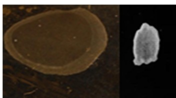
Obr. 0-5: Vzorek 3.1:(doba černění 15 min.)_Nevyhovující korozivní odolnost, došlo k úplnému rozpuštění povlaku
