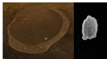
Obr. 0-4: Vzorek 2.2:(doba černění 10 min.)_Nevyhovující korozivní odolnost, došlo k úplnému rozpuštění povlaku
