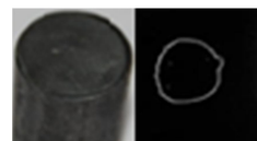
Obr. 5-6: Vzorek 6:(doba černění 45 min.)_Vyhovující korozivní odolnost, došlo k částečnému naleptání povlaku ne k jeho rozpuštění
