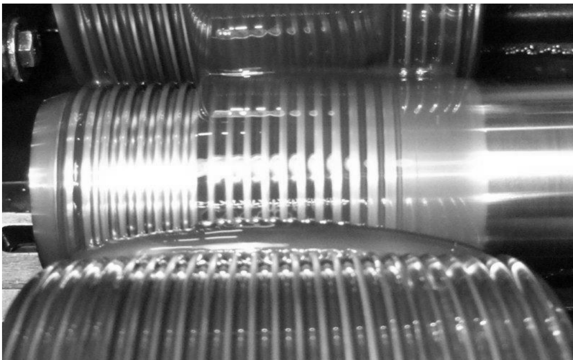
Obr. 2-4: Ukázka vzniku povrchu pomocí tvářením za studena (přeměna kruhové tyčoviny v závit)[13]
