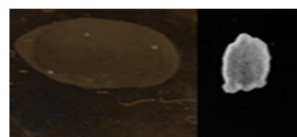
Obr. 3-14: Vzorek 7.2:(doba černění 35 min.)_Nevyhovující korozivní odolnost, došlo k úplnému rozpuštění povlaku
