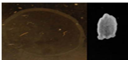
Obr. 3-11: Vzorek 6.1:(doba černění 30 min.)_Nevyhovující korozivní odolnost, došlo k úplnému rozpuštění povlaku
