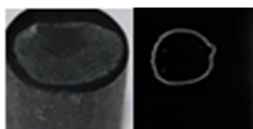
Obr. 5-5: Vzorek 5:(doba černění 40 min.)_Vyhovující korozivní odolnost, došlo k částečnému naleptání povlaku ne k jeho rozpuštění
