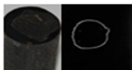
Obr. 6-4: Vzorek 4:(doba černění 30 min.)_Vyhovující korozivní odolnost, došlo k částečnému naleptání povlaku ne k jeho rozpuštění
