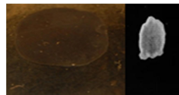
Obr. 0-10: Vzorek 5.2:(doba černění 25 min.)_Nevyhovující korozivní odolnost, došlo k úplnému rozpuštění povlaku
