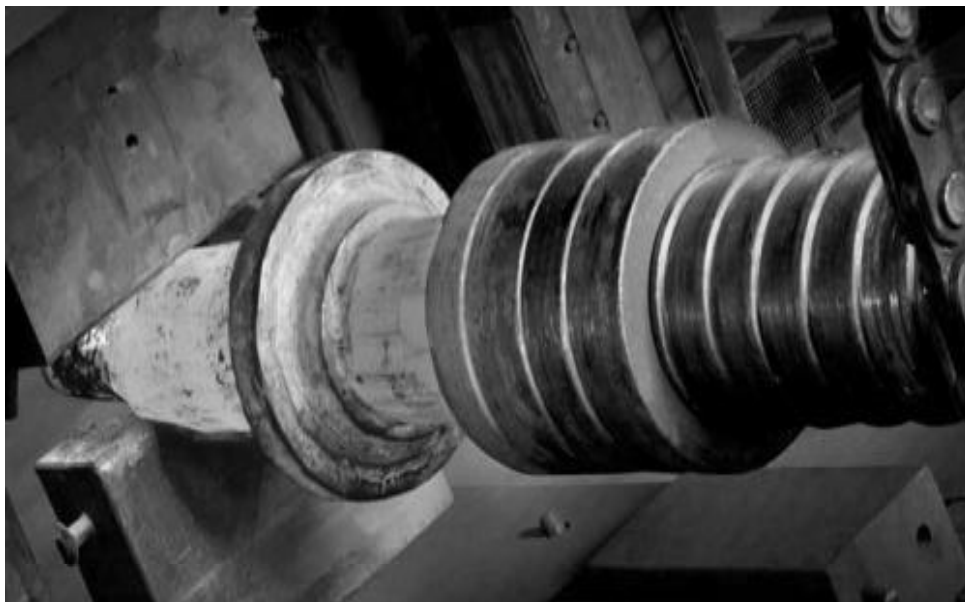
Obr. 2-3: Ukázka vzniku nového povrchu pomocí kování (kování zalomeného čepu klikové hřídele)[6]
