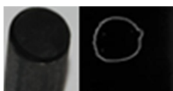
Obr. 7-4: Vzorek 4:(doba černění 30 min.)_Vyhovující korozivní odolnost, došlo k částečnému naleptání povlaku ne k jeho rozpuštění
