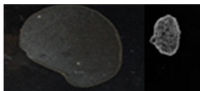
Obr. 0-3: Vzorek 2.1:(doba černění 10 min.)_Nevyhovující korozivní odolnost, došlo k úplnému rozpuštění povlaku
