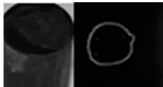
Obr. 7-2: Vzorek 2:(doba černění 10 min.)_Vyhovující korozivní odolnost, došlo k částečnému naleptání povlaku ne k jeho rozpuštění
