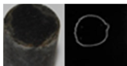
Obr. 5-4: Vzorek 4:(doba černění 30 min.)_Vyhovující korozivní odolnost, došlo k částečnému naleptání povlaku ne k jeho rozpuštění
