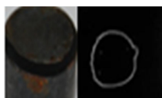
Obr. 6-5: Vzorek 5:(doba černění 40 min.)_Vyhovující korozivní odolnost, došlo k částečnému naleptání povlaku ne k jeho rozpuštění
