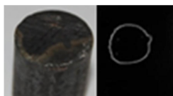
Obr. 5-2: Vzorek 2:(doba černění 15 min.)_Vyhovující korozivní odolnost, došlo k částečnému naleptání povlaku ne k jeho rozpuštění
