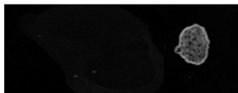
Obr. 2-6:Vzorek 3.1:(doba černění 15 min.)_Nevyhovující korozivní odolnost, došlo k částečnému rozpuštění povlaku
