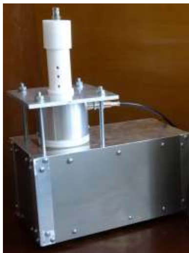
Obrázek IV. Diagnostická jednotka pro sledování rozložení prostorového náboje
