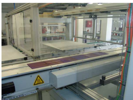
Obr. 1.8 Automatická linka - řada propojených PV článků
