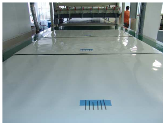
Obr. 1.13 Přidání podkladové folie - připraveno k lisu
