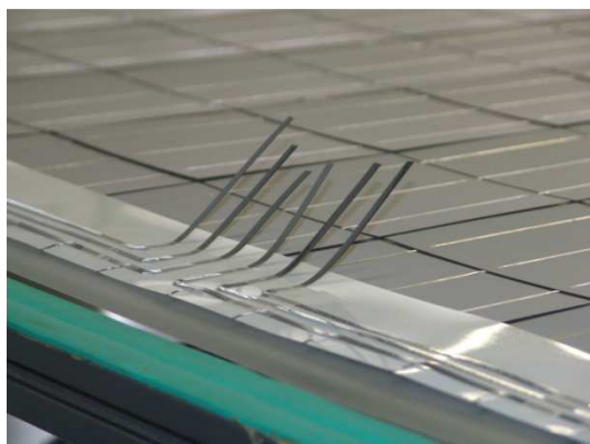
Obr. 1.12 Ručně propojené řady PV článků s vyvedenými kontakty
