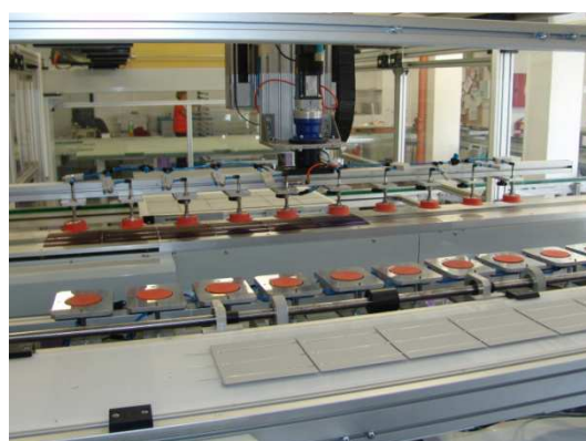
Obr. 1.9 Automatická linka – složení jednotlivých řad do konečného tvaru
