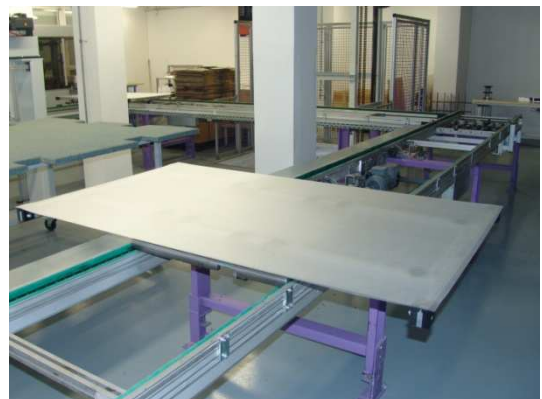
Obr. 1.5 Posuvný stůl s ochranným sklem a EVA folií - připraveno pro uložení PV článků
