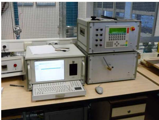
Obr. 3.4 Vyhodnocovací jednotka LDV-5, vysokonapěťový napájecí systém - LM 30 a ovládací panel SM 4
