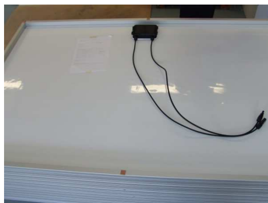
Obr. 1.17 Připojení krabičky s výstupními kontakty
