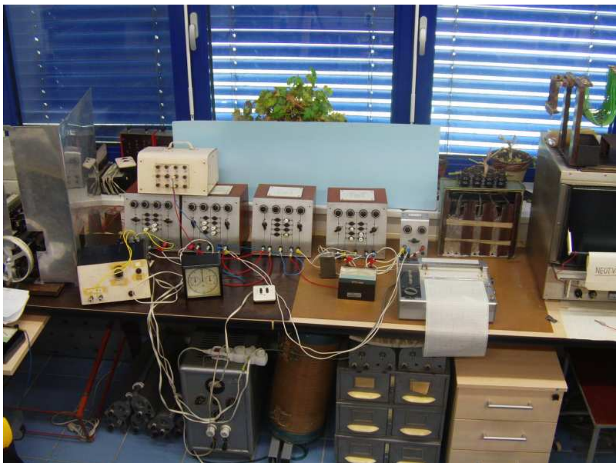
Obr.3 Měření na nastavitelném modelu v laboratořích FEL. Čtyři velké bloky uprostřed představují nastavitelné T – členy. Napravo je připojeno záznamové zařízení – oscilograf.
