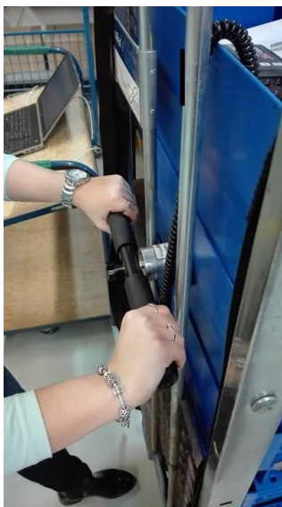
Obrázek 43 - Měření tlačných sil na ručním vozíku za použití sady ergoPAK
