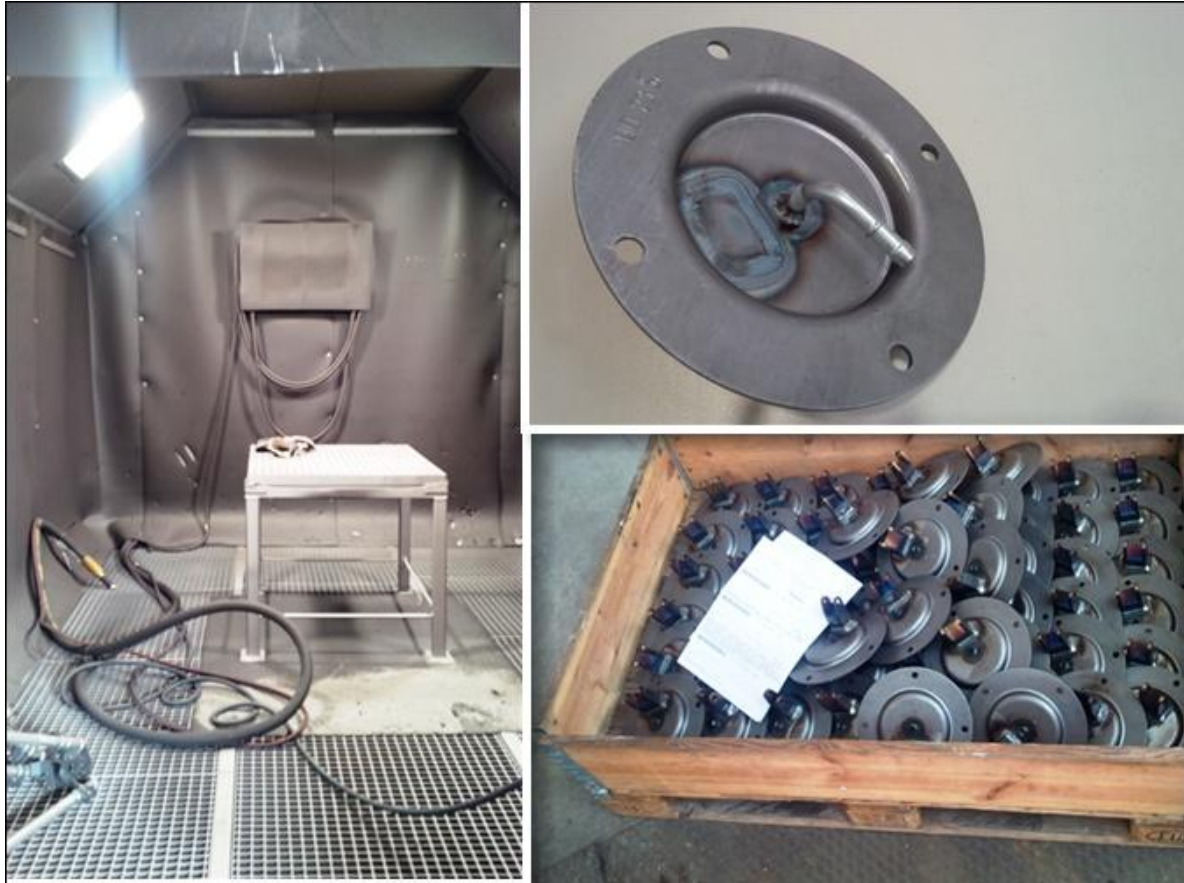
Obrázek 27 - Tryskací komora, Svařená příruba, Fronta přírub čekající na pískování [8]
