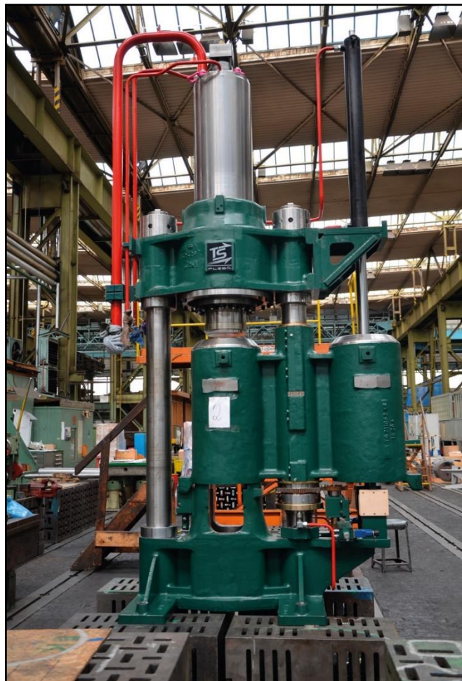
obr. 5-4 Lis na střelný prach CFN 320 [9]
