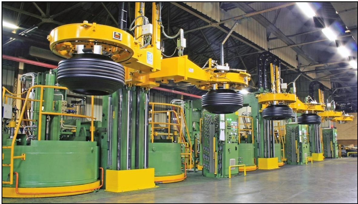
obr. 5-3 Hydraulické vulkanizační lisy 75" [9]
