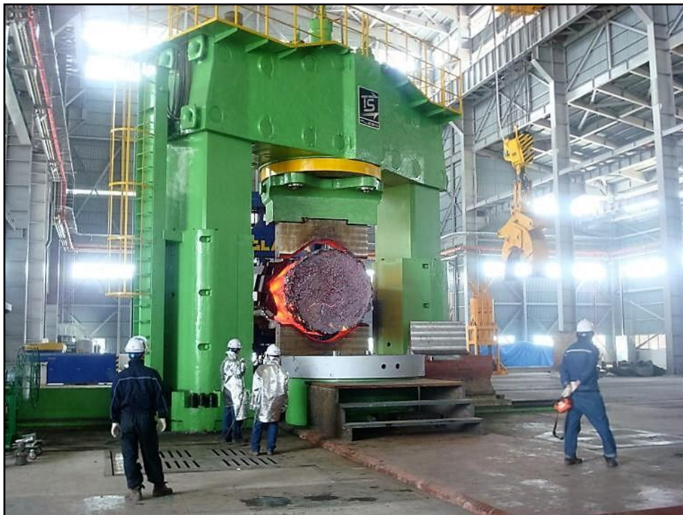
obr. 5-2 Hydraulický kovací lis CKW 6000/8000t [9]
