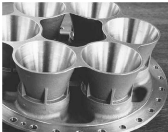
Obr. 40: Odlitek raketové trysky [31]
