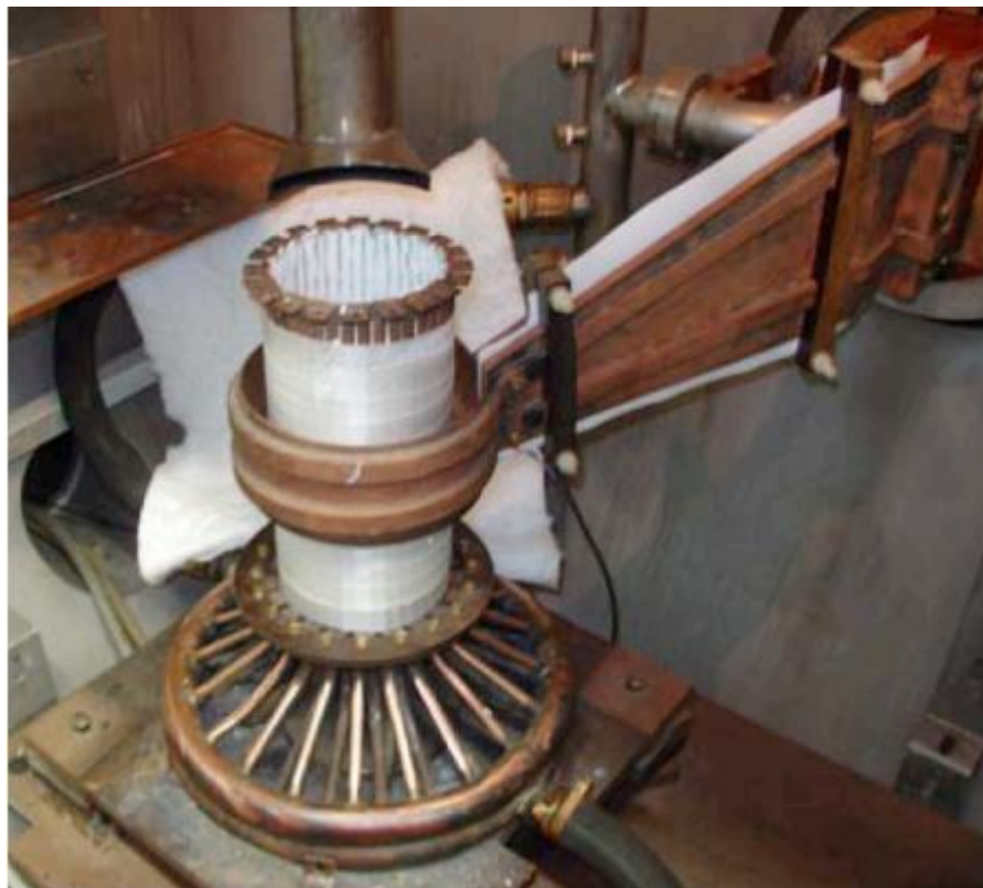
Obr. 23: Klasický studený kelímek tvořený segmenty [18]
