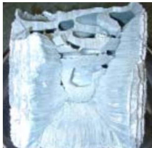
Obr. 36: Ingot ZrO_2 po vychladnutí [18]
