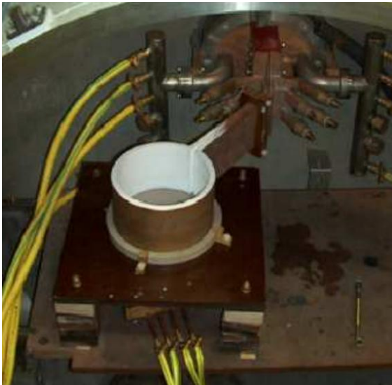
Obr. 19: Reálný kelímek s integrovaným induktorem [21]
