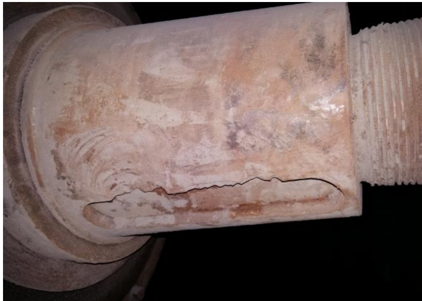
Obr. 4-5 – Porucha – poškozená hřídel soustrojí VM 91 [48]
