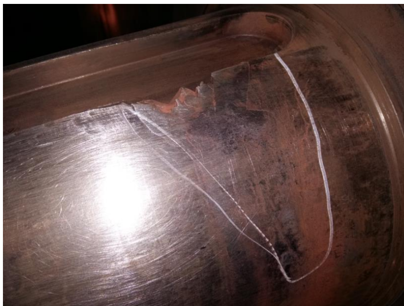
Obr. 4-6 – Porucha – poškozená hřídel soustrojí VM 93 [49]
