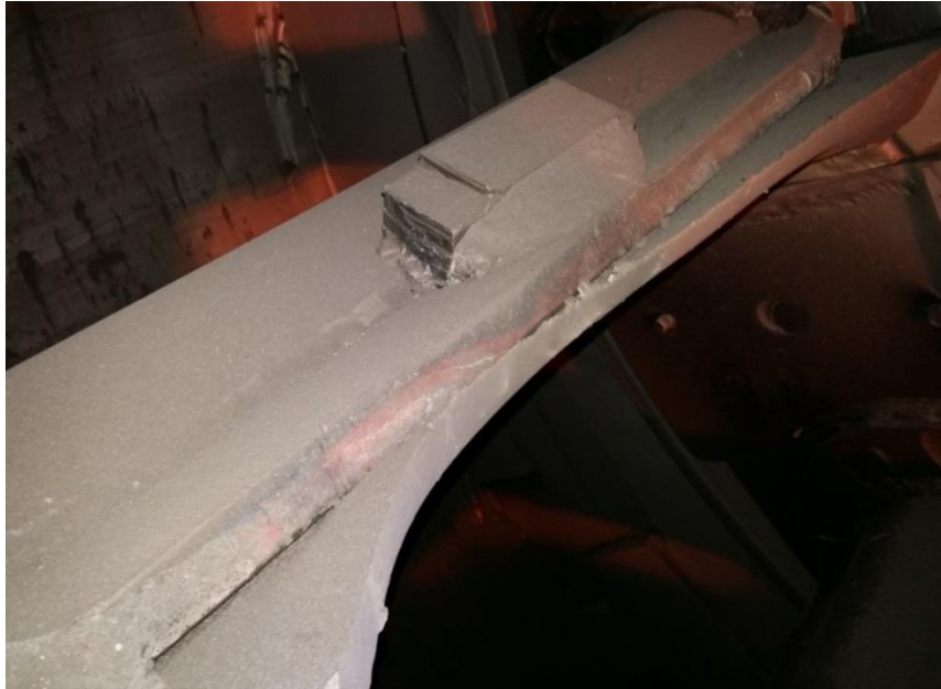
Obr. 3-2 – Maximální opotřebení mlecí desky - ETI [33]
