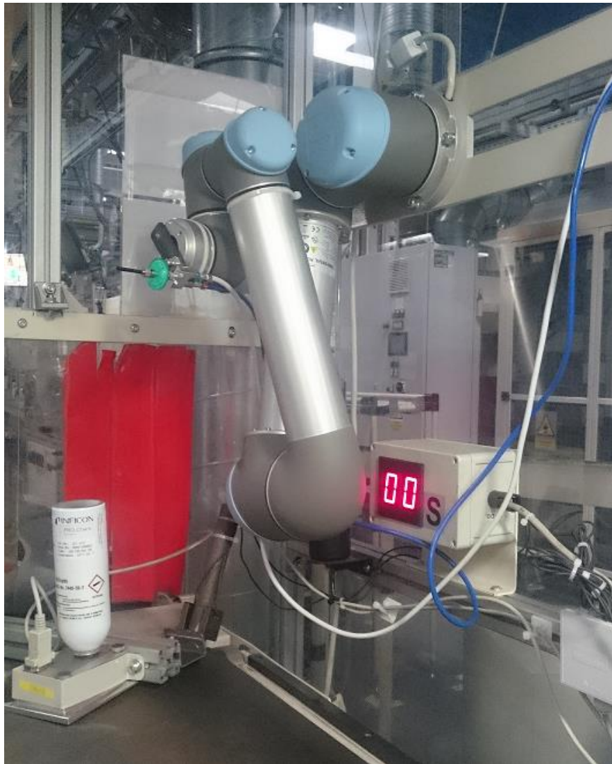
Obr. 4-11 Umístění testovacího robota UR5 na zadní straně kabiny [19]
