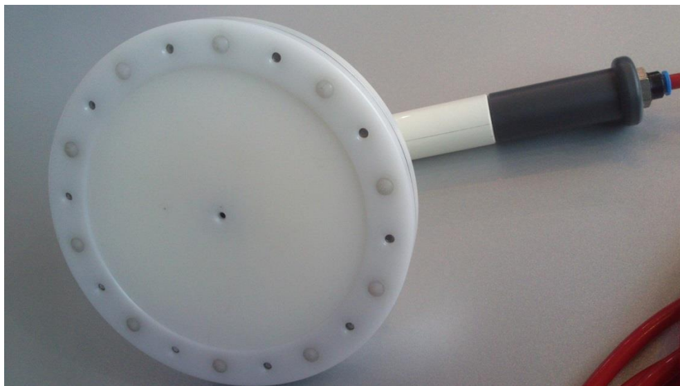
Obr. 4-7 Nástavec sondy pro testování velkých rovinných ploch [14]
