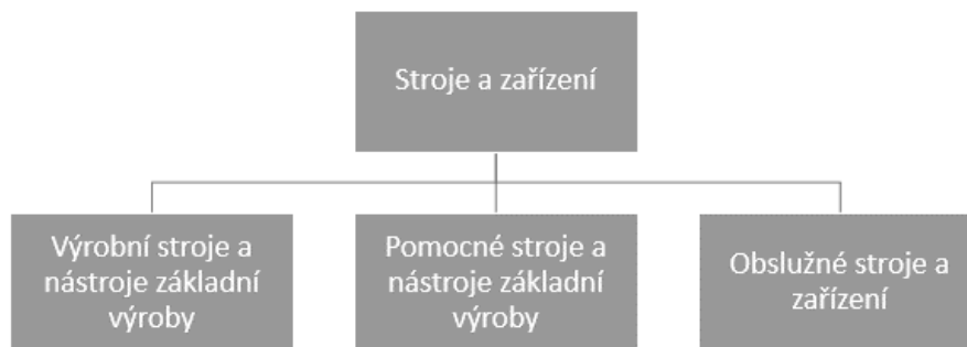
Obrázek 1-6 Základní rozdělení strojů a zařízení [2]
