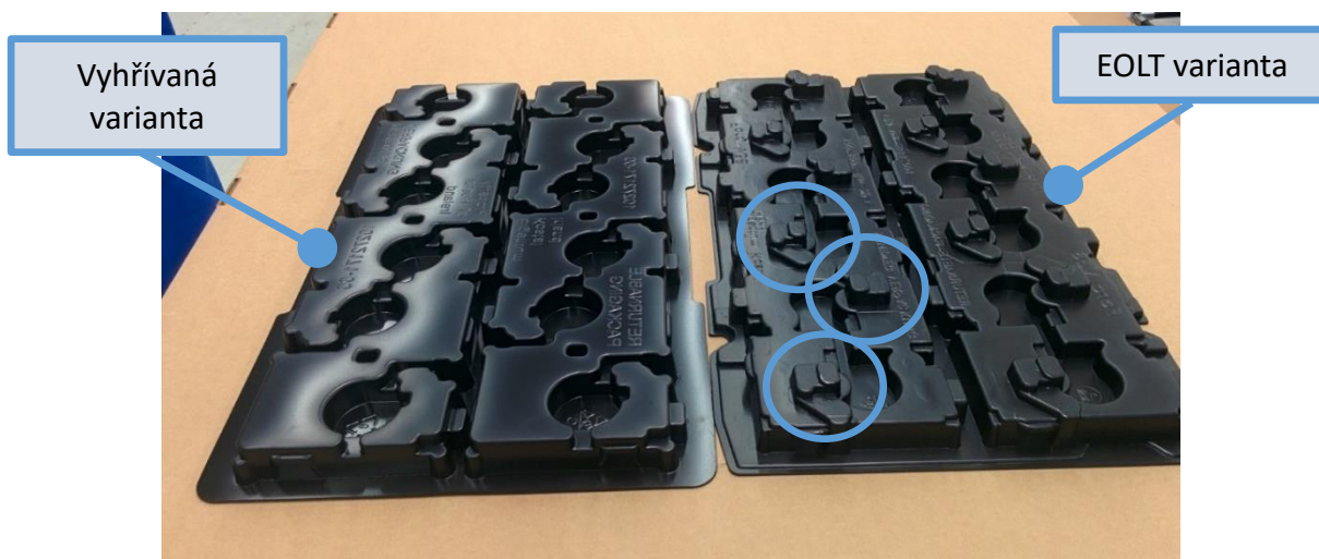
Obrázek 53 Porovnání PCB plat EOLT a vyhřívané varianty [vlastní]
