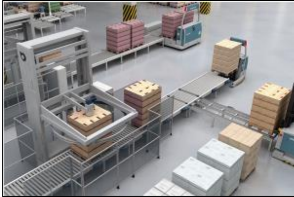
Obrázek2- 19: Automatická nakládka a odjezd AGV [27], 2016
