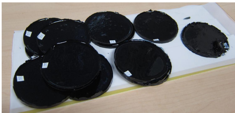
Dedopované vzorky s PANI-H 2 SO 4 , u některých došlo vlivem odpaření tvrdidla v ultrazvuku ke sražení polyanilinu
