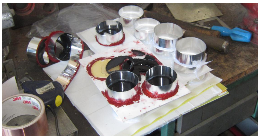
Nezdařené pokusy o tepelné vytvrzení vzorků
