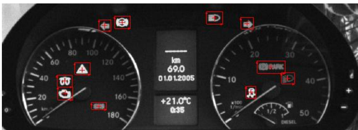
Obrázek 8-13 Fotografie z průběhu testu (detekce kontrolek)
