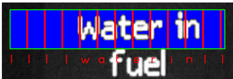
Obrázek 8-26 Ukázka rozdělení textu do polí podle velikosti znaků
