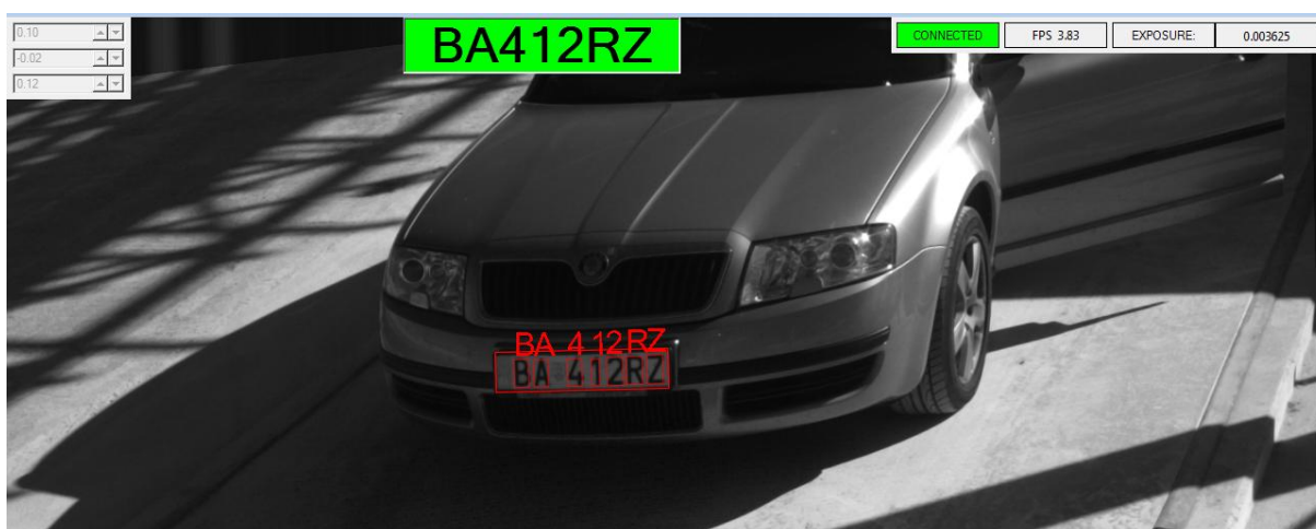
Obrázek 6-9 Ukázka automatického přečtení registrační značky [14]
