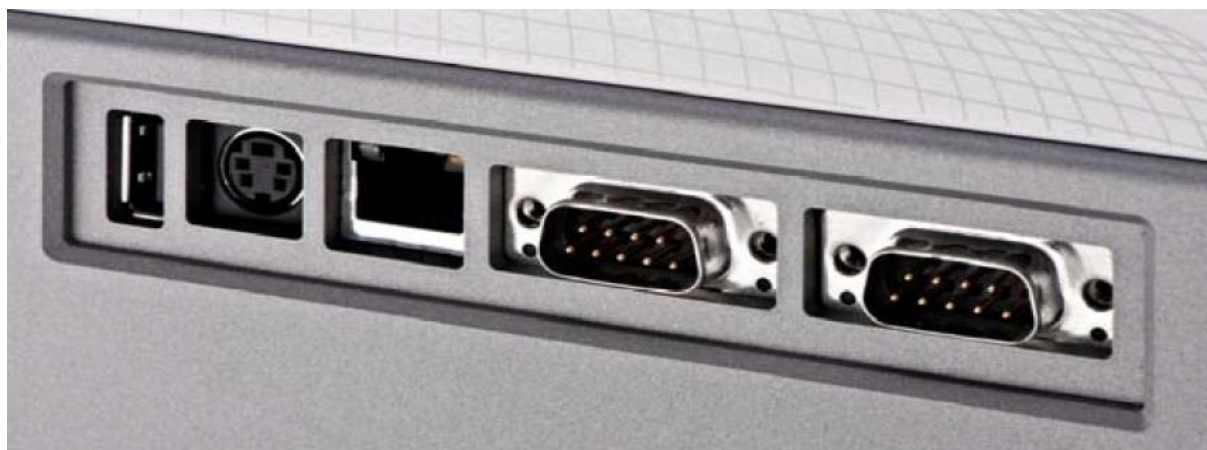
Obrázek 3-2 Externí rozhraní FPGA-boxu [4]
