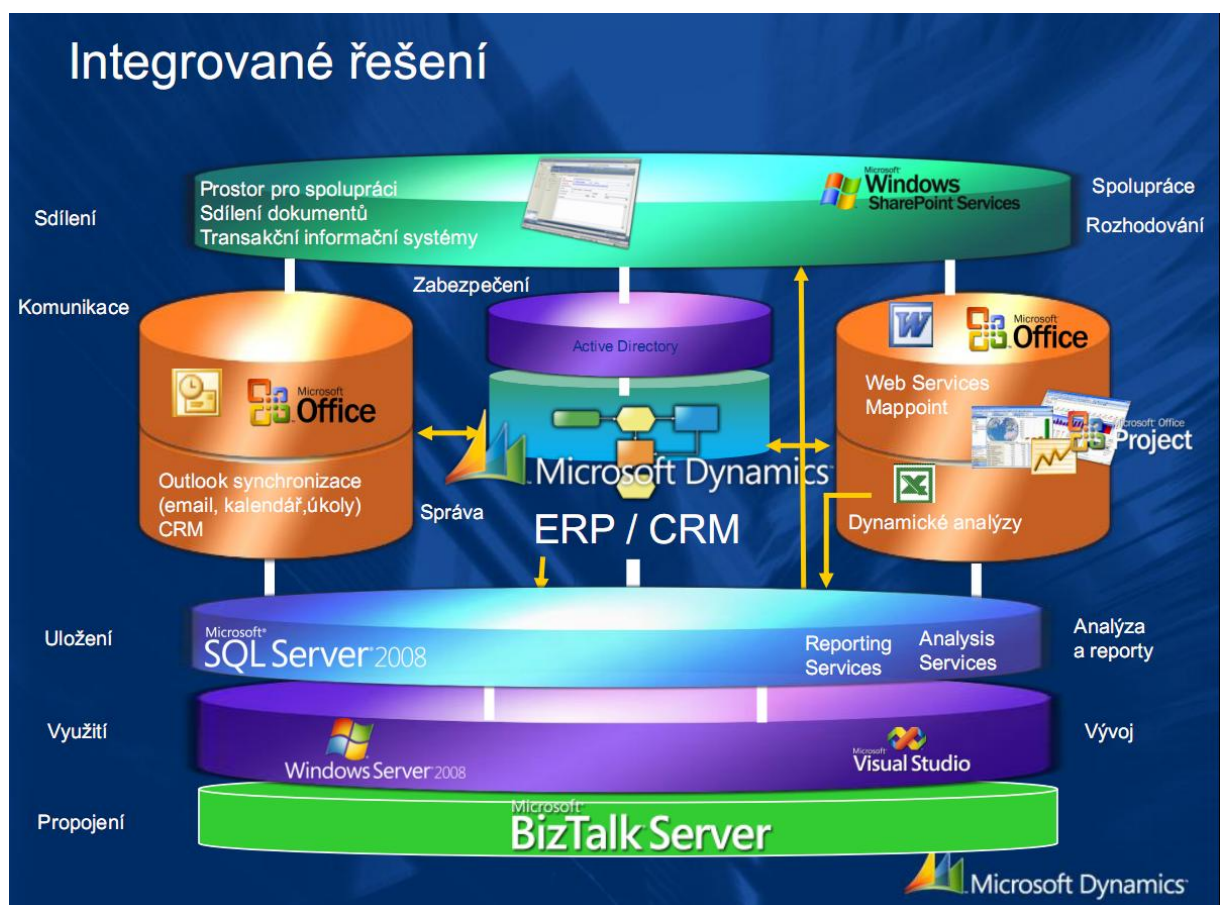
Obr. 15 Modelové řešení integrace Microsoft Dynamics CRM pomocí BizTalk Serveru
