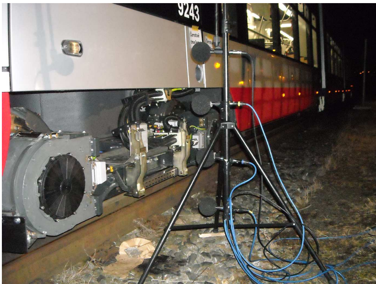
Obr. 4.4b: Rozmístění mikrofonů při měření v oblasti podvozků – foto
