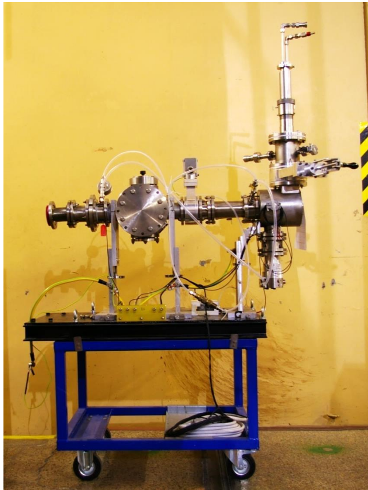
Obr. 9: Lithiová terčová stanice, převzato z [11]
