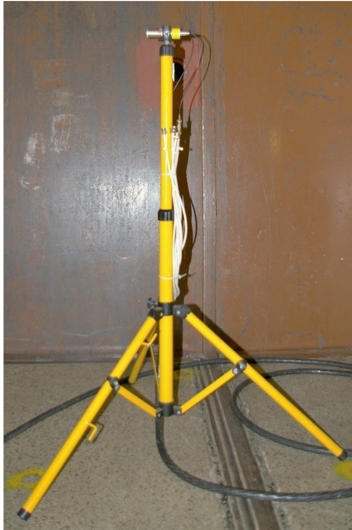
Obr. 21: Scintilační detekční jednotka umístěna ve stojanu
