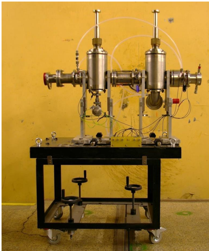
Obr. 10: Beryliová terčová stanice
