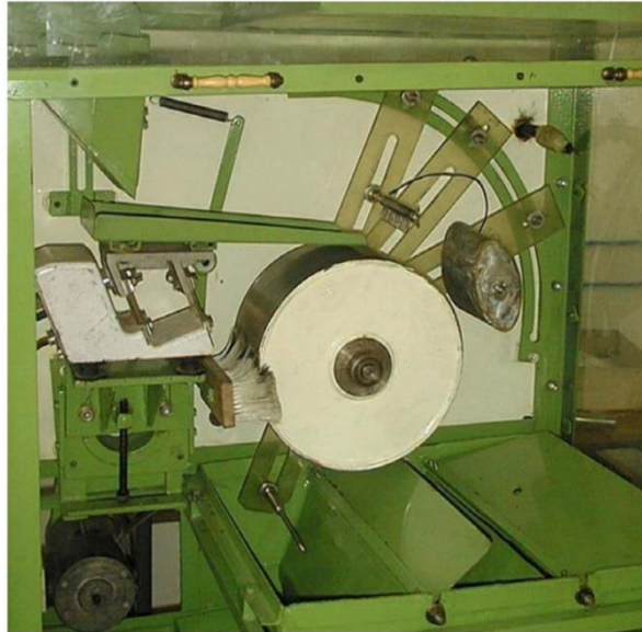
Obr. 2 Elektrostatický separátor rozdrčených kabelů [16]
