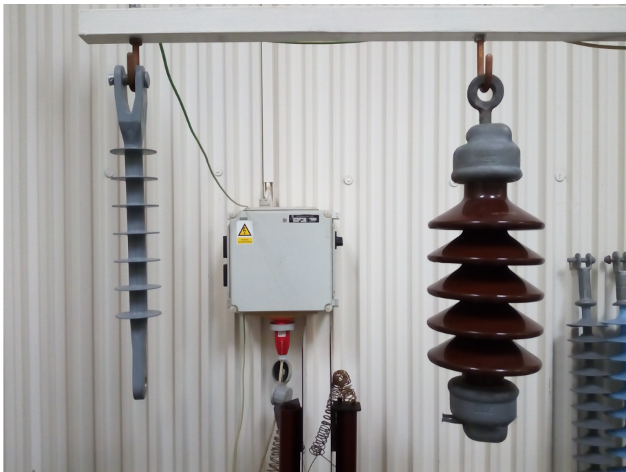
Obr.30 Vlastní měření izolátory (levý silikonový, pravý keramický)
