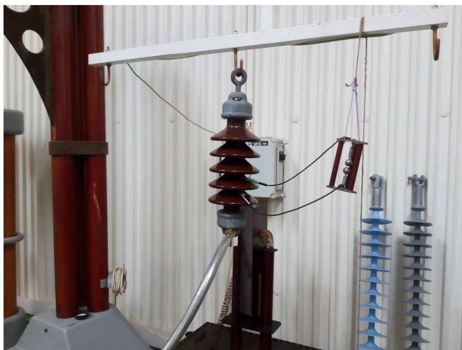
Obr.31 Vlastní měření (izolátor + měřicí jiskřiště)
