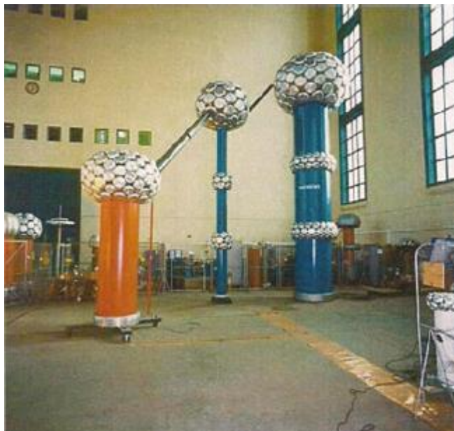
Obr 2.4 Napěťový dělič během kalibrace [1]
