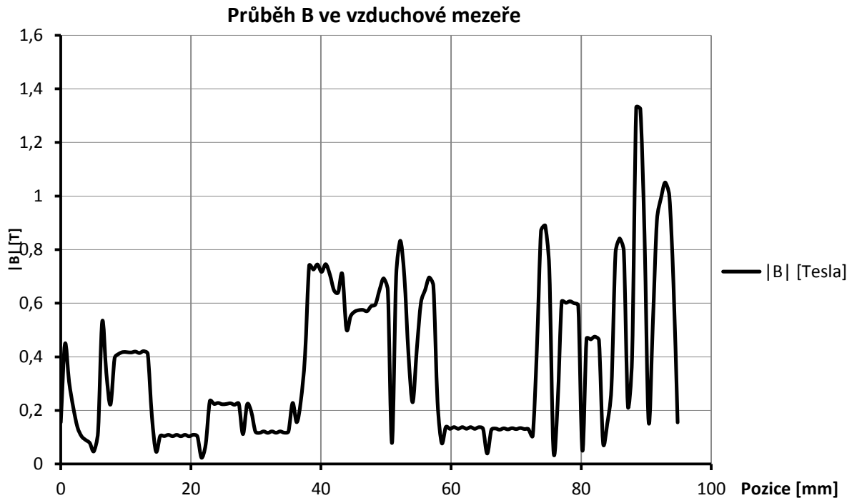
Obrázek 34 - Průběh |B| ve vzduchové mezeře
