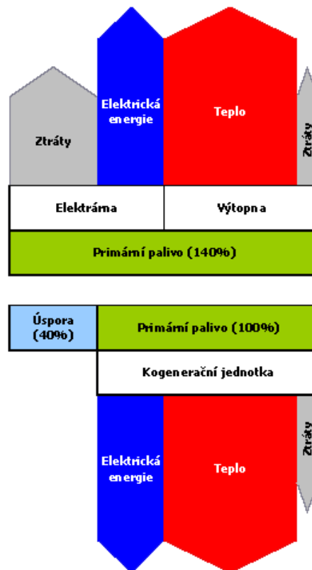
Obr. 1. 1: Úspora paliva u kogeneračních zdrojů [15]
