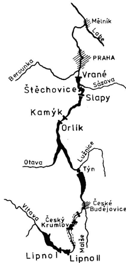
Obr. 4: Schéma Vltavské kaskády vodních elektráren [7]
