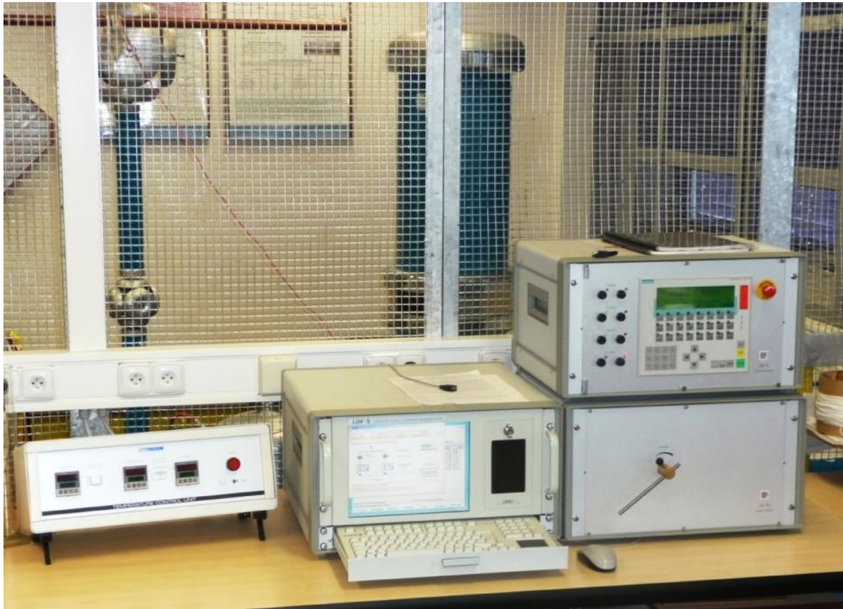
Automatický měřicí systém LDV – 5 a kontrolní panel vyhřívaného elektrodového systému.
