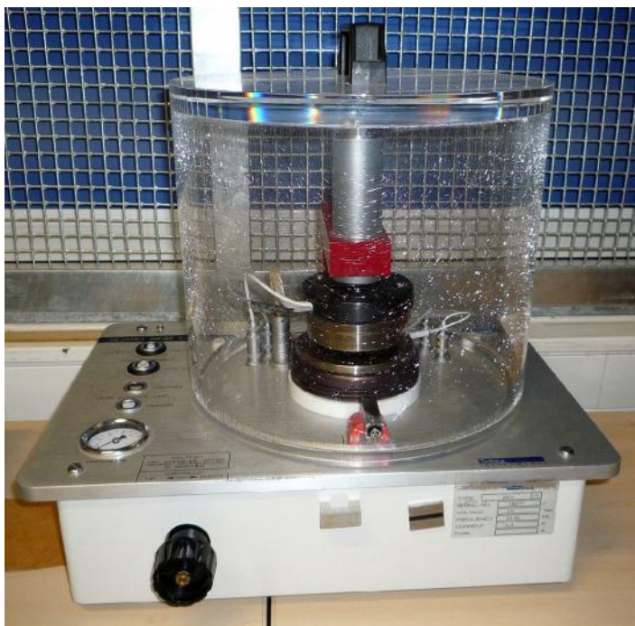
Vyhřívaný elektrodový systém Firmy Tettex Instruments.
