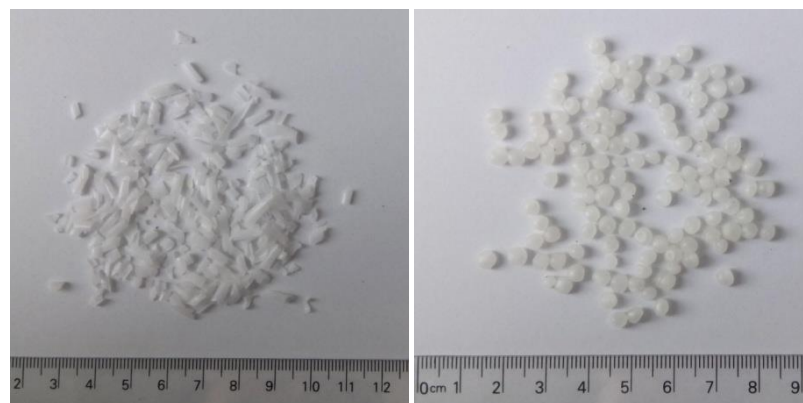
Obrázek 21 POM (vlevo) ABS (vpravo)
