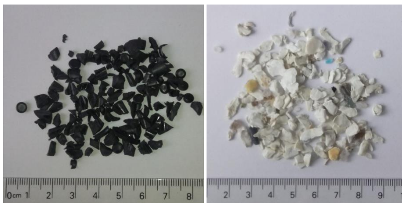
Obrázek 20 PVC (vlevo) PS – ledničky (vpravo)
