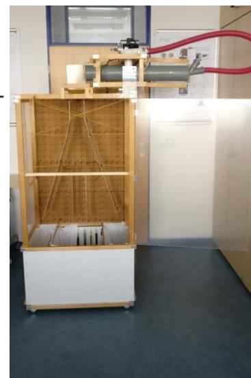
Obrázek 17 Dvoustupňový separátor free-fall s popisem
