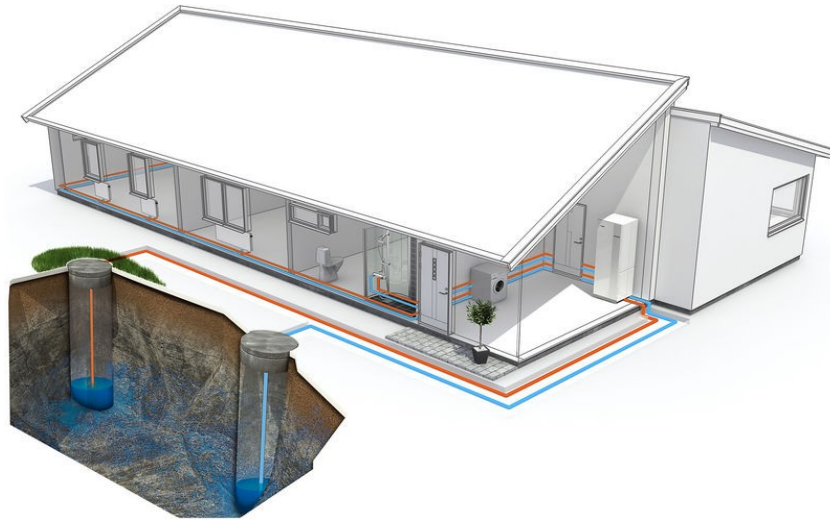
Obr. 7 Ukázka TČ voda/voda s výparníkem ve studni [8]
