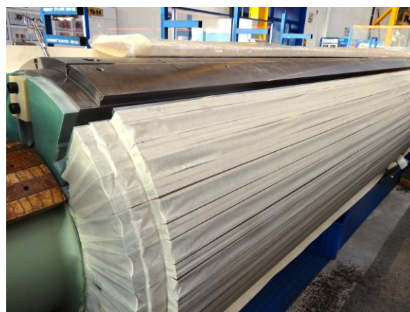
Obr. 66 Zakrytí drážek lepicí páskou
