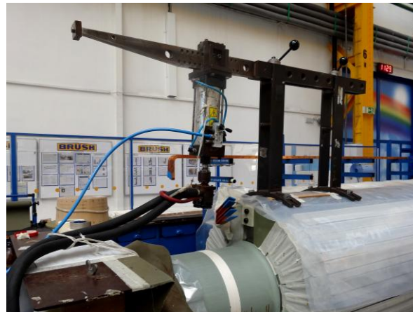
Obr. 127 Konstrukce připevňena k rotoru
