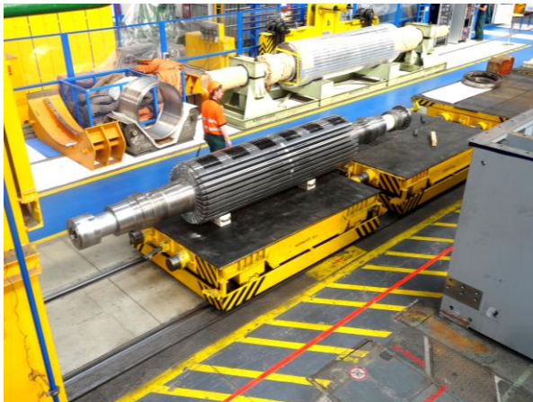
Obr. 63 Kolejový převoz rotoru do pracoviště
