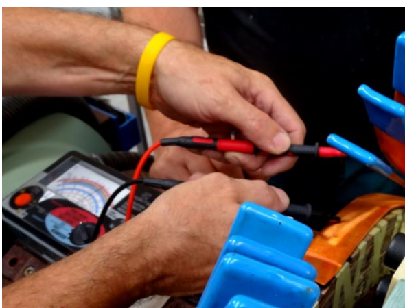
Obr. 80 Zkoušení vodičů proti zkratu
