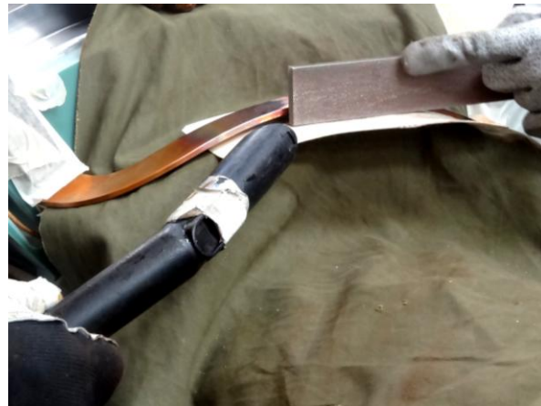
Obr. 104 Boční pilování a odsávání pilin
