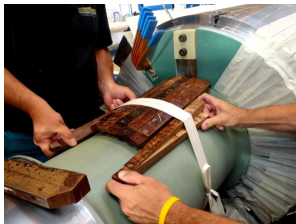
Obr. 84 Skládání dřevěných podkladů
