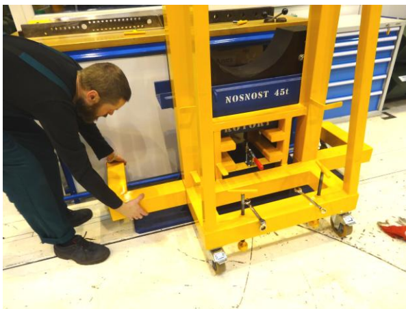
Obr. 158 Demontáž nohou konstrukce
