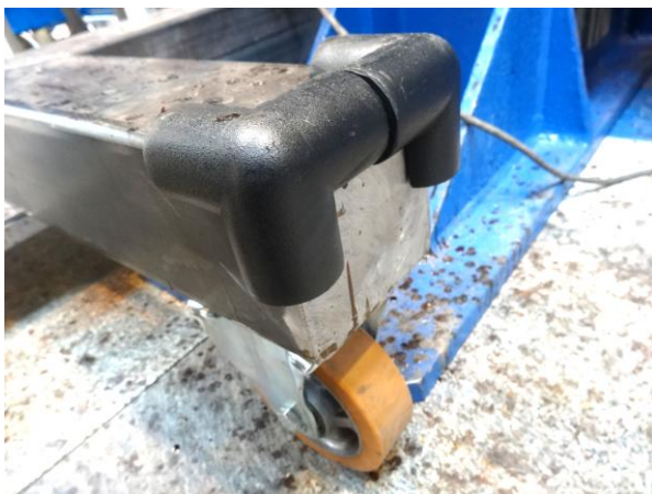
Obr. 155 Bezpečnostní zakrytí nohou konstrukce
