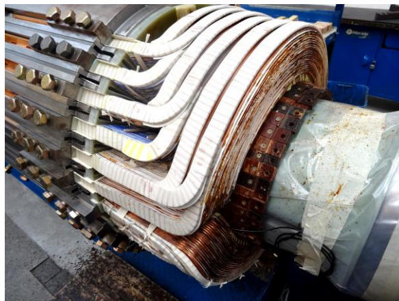
Obr. 58 Zaizolované rotorové vinutí
