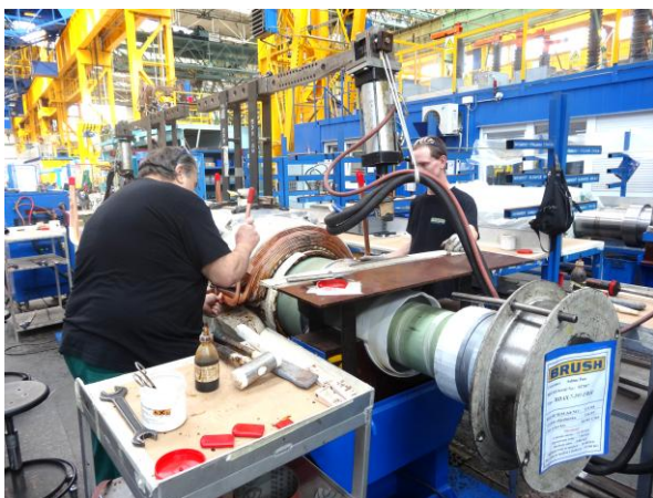
Obr. 49 Dvojice pracovníků Navíjení rotorů
