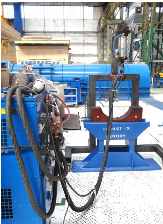
Obr. 141 Prototyp se svářecím zařízením
