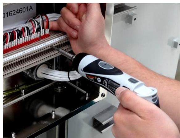
Obr. 3 Montáž akumulátorovým šroubovákem
