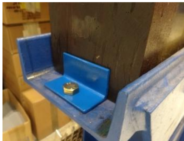
Obr. 26 Opatření proti vyosení rotoru
