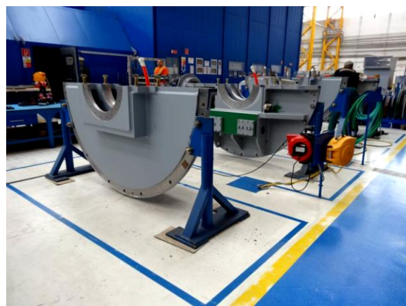
Obr. 60 Pracoviště tlakování štítů
