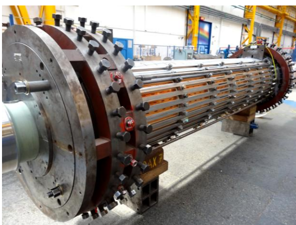
Obr. 113 Vinutí staženo stahovacím zařízením
