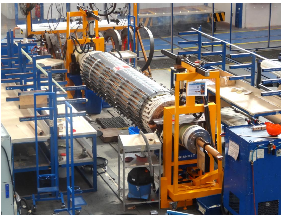
Obr. 164 Pracoviště Navijárny rotorů osazené optimalizovanými pájecími konstrukcemi
