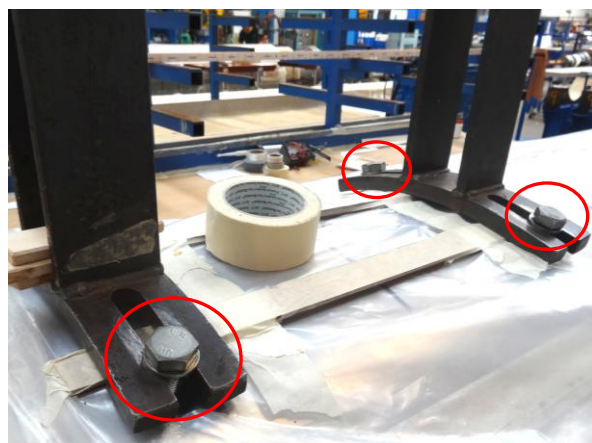
Obr. 118 Uchycení pájecí konstrukce šrouby
