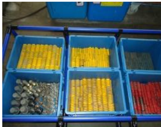
Obr. 22 Roztříděné pružiny razidel v boxech
