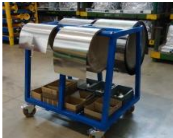
Obr. 20 Výroba pojízdné konstrukce se svitky
