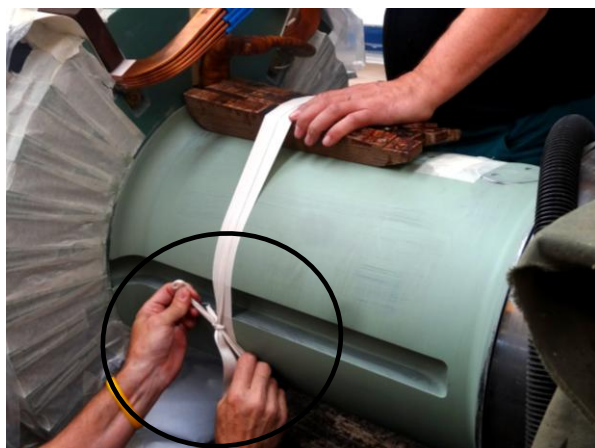
Obr. 85 Uvázání podkladů provázkem
