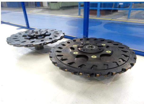
Obr. 8 Způsob odložení fréz před optimalizací
