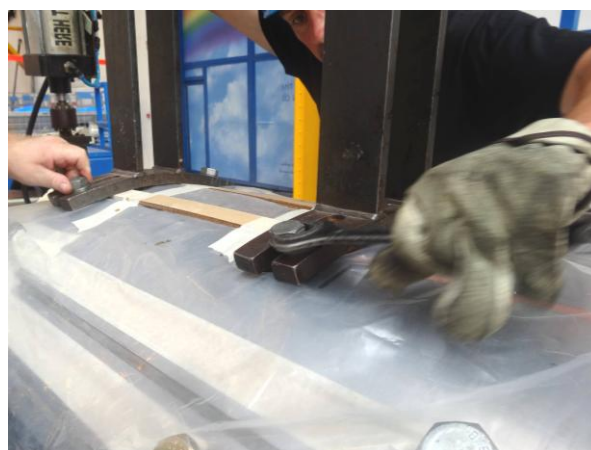
Obr. 121 Demontáž šroubů konstrukce
