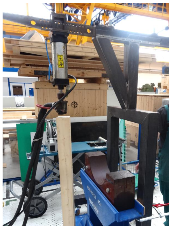
Obr. 142 Testování konstrukce tlakem pístu
