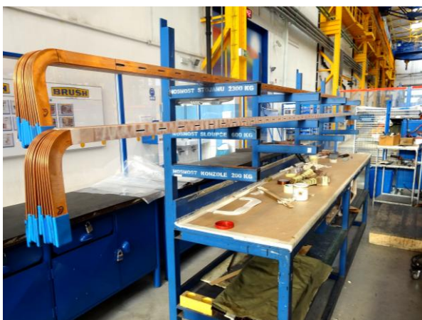
Obr. 71 Stojan na pracovišti pro měděné cívky
