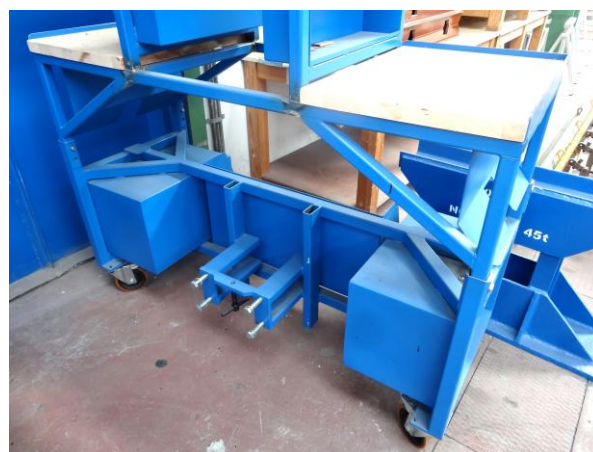
Obr. 146 Starší typ pájecí konstrukce
