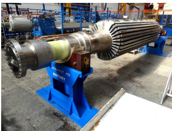
Obr. 65 Obrobený výkovek rotoru
