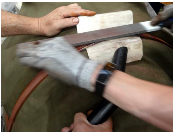
Obr. 103 Vrchní pilování a odsávání pilin
