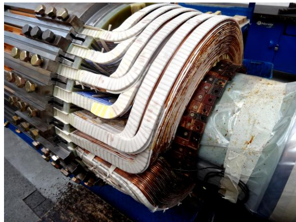
Obr. 79 Navinutý rotor o 6 cívkách
