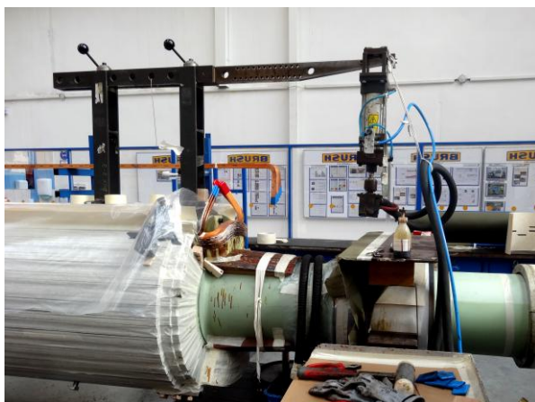
Obr. 73 Pájecí konstrukce uchycená k rotoru
