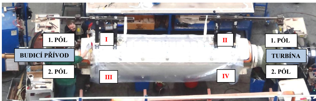
Obr. 75 Boční pohled na rotor s namontovanými pájecími konstrukcemi
