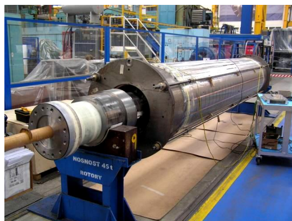
Obr. 114 Vinutí staženo lisovacím přípravkem
