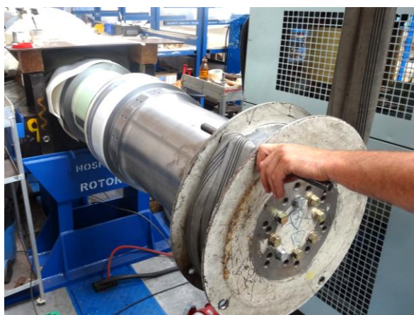
Obr. 124 Natočení rotoru na protilehlý pól
