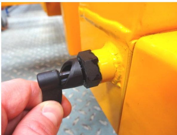
Obr. 160 Zajišťovací mechanismus nohy
