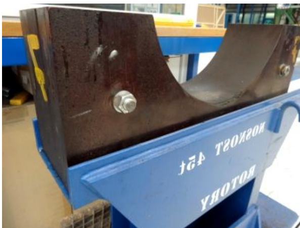
Obr. 25 Nevhodné vysunutí podvalku
