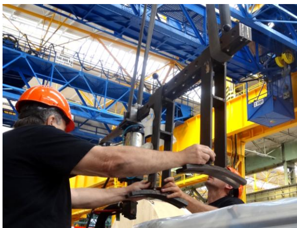
Obr. 122 Demontáž pájecí konstrukce
