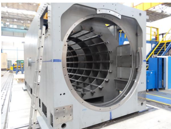
Obr. 55 Svařená kostra statoru
