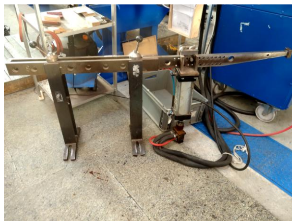
Obr. 72 Pájecí konstrukce s pístem
