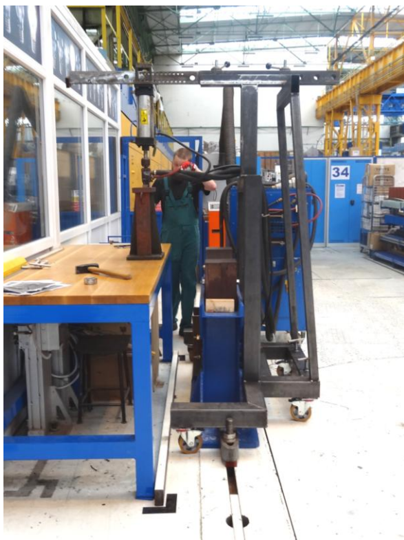
Obr. 149 Testování konstrukce tlakem pístu
