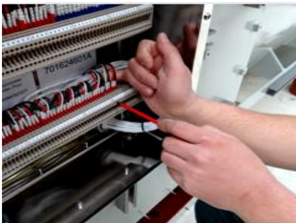
Obr. 2 Montáž klasickým šroubovákem
