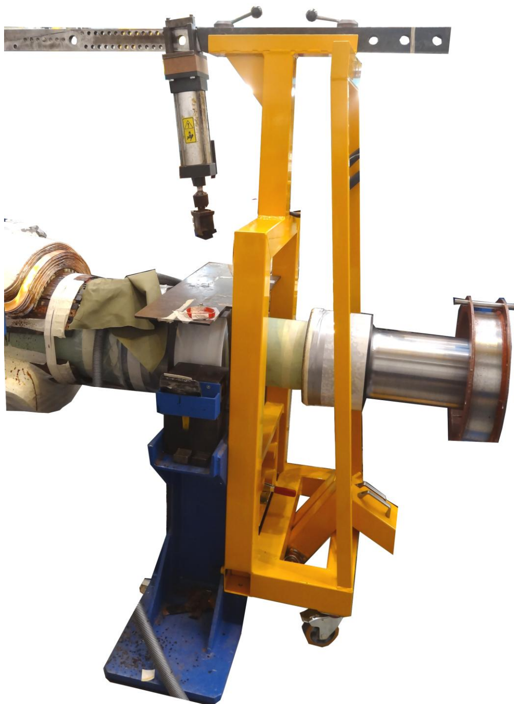
Obr. 162 Výsledná verze pájecí konstrukce připevněná k nosnému stojanu na pracovišti
