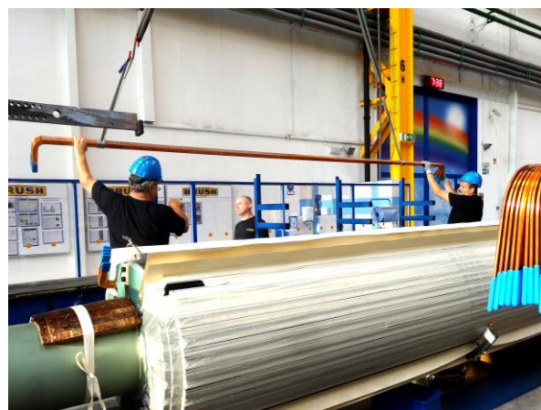
Obr. 70 Převoz cívek na stanoviště navíjení
