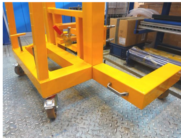
Obr. 161 Madlo nohy konstrukce
