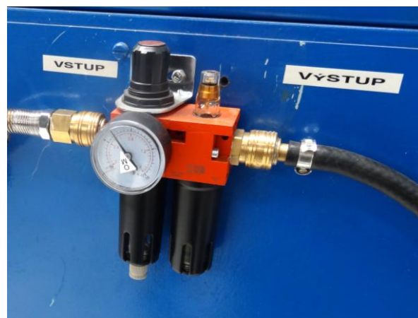
Obr. 100 Zdroj tlaku pro tlakové svařování
