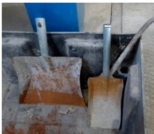
Obr. 6 Lopatka před optimalizací
