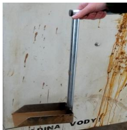
Obr. 7 Úprava lopatky po optimalizaci
