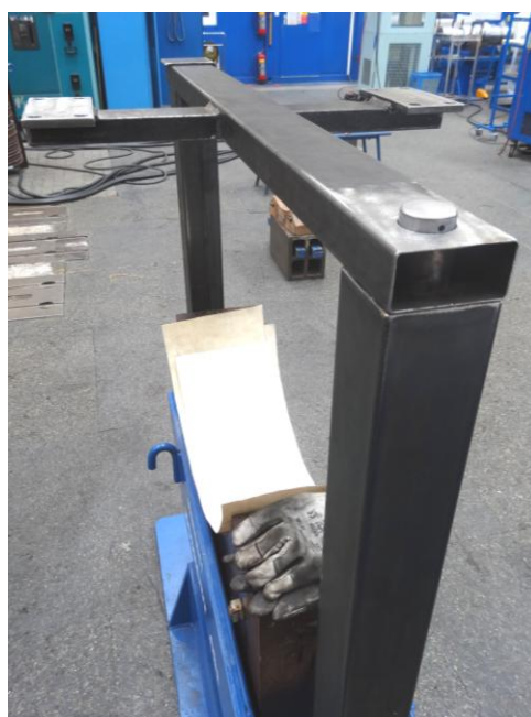
Obr. 137 Hrazdová pájecí konstrukce
