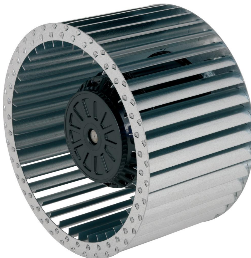
Obrázek 3 Radiální ventilátor se zahnutými lopatkami dopředu bez spirální skříně[3]
